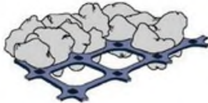
Рисунок 10 – Заклинювання щебеню в отворах геосітки
