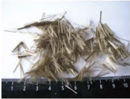
Рисунок 4 – Базальтове рублене волокно (базальтова фібра). Діаметр елементарних волокон 16 мікрон, довжина 12 мм
