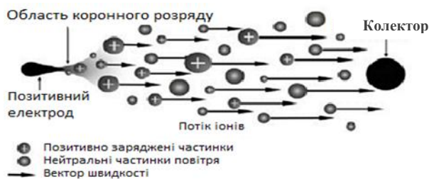
Рис. 1. Електрокінетична модель створення рушійної сили
