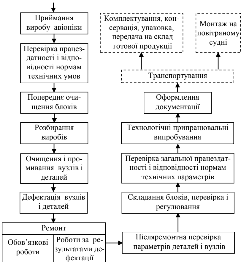
Рис. 6.4. Схема технологічного процесу ремонту виробів авіоніки в цеху авіаремонтного заводу
