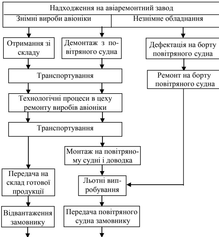
Рис. 6.3. Схема технологічного процесу на авіаремонтних заводах
