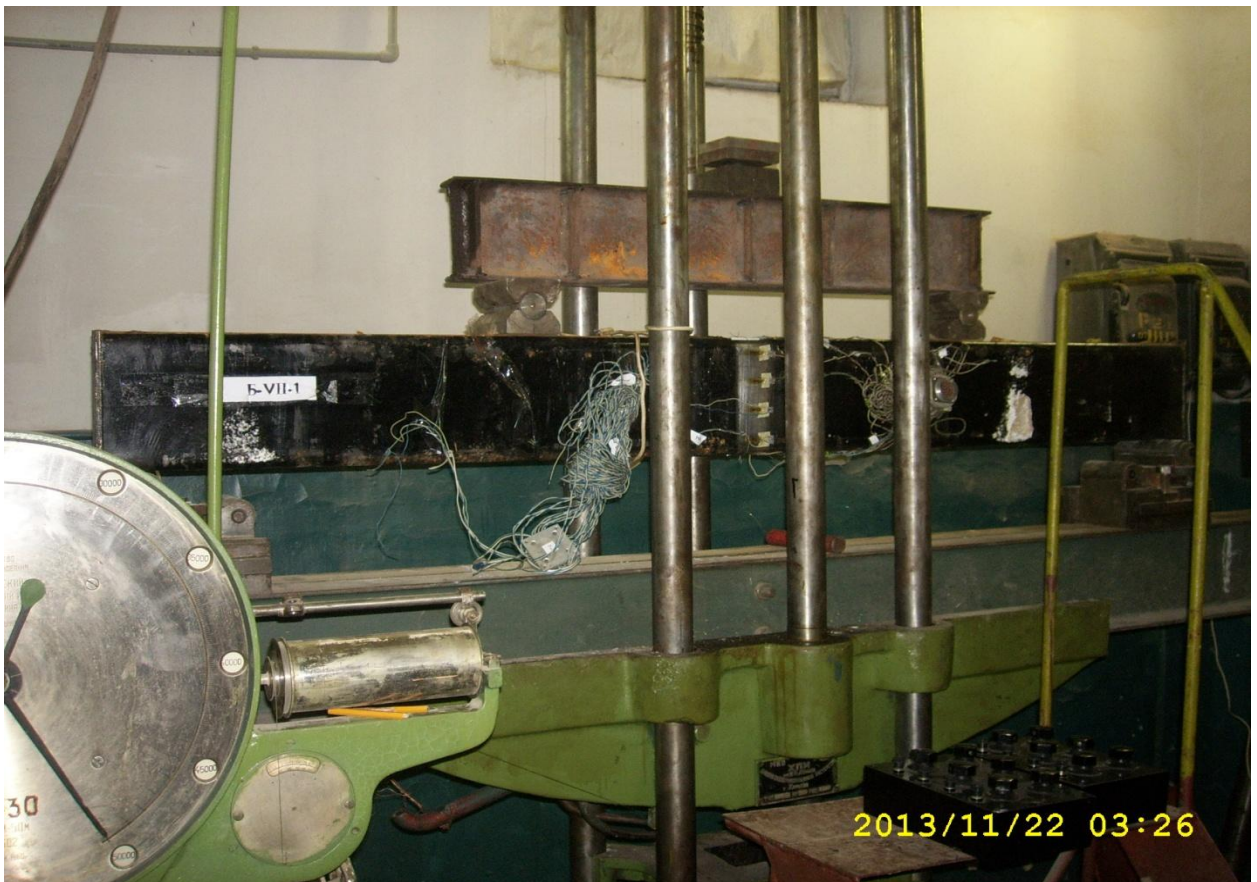
Рисунок 3.1 – Прес для випробування зразків по нормальному перерізу ПММ-250
