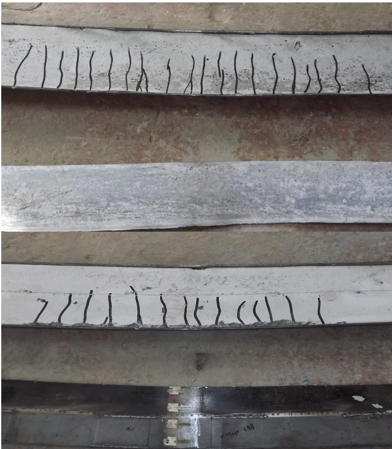
Рисунок 4.5 – Характери руйнування експериментальних зразків Бм-1-2 та Бм-3-2
