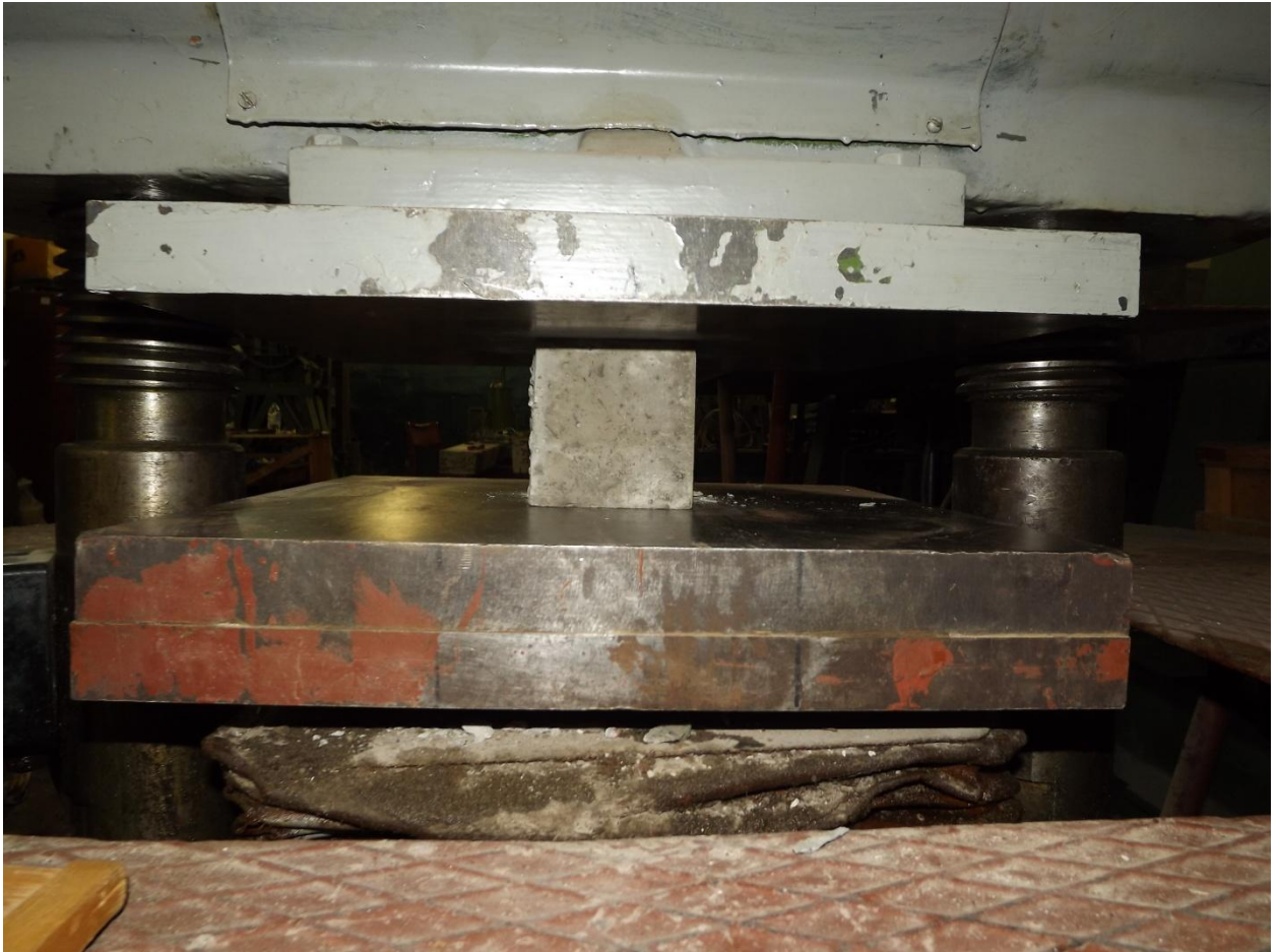
Рис. 3.4. Випробовування бетонного контрольного зразка на пресі 2ПГ-125.
