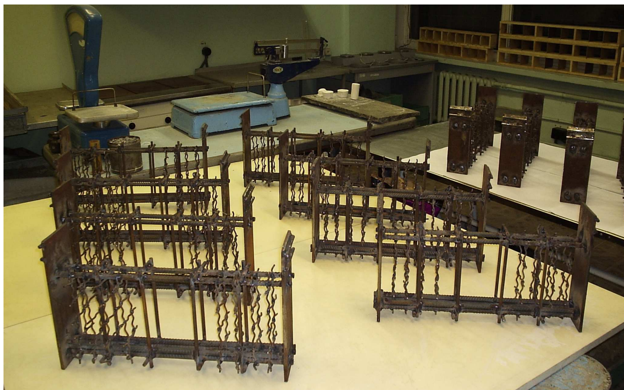
Рис. 2.4. Арматурные каркасы экспериментальных образцов
