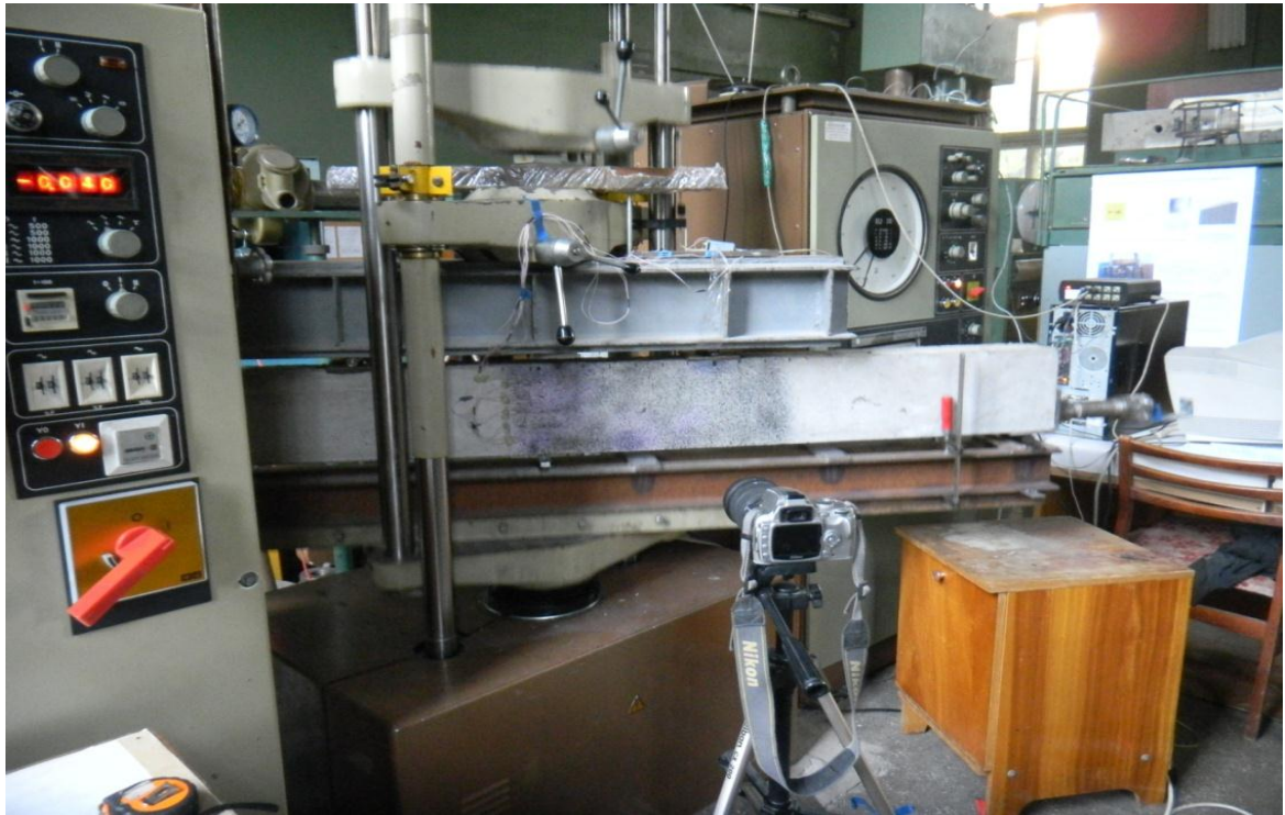
Рис. 2.7. Стенд для випробування дослідних зразків балок на статичні та багатоциклові навантаження
