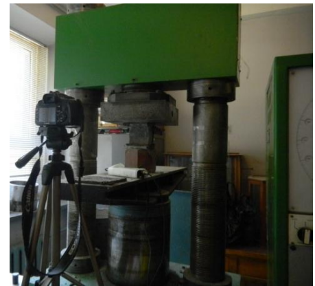
Рис. 2.3. Схема випробування бетонного куба на осьовий стиск (а); Загальний вигляд випробування (б): 1 – дослідний зразок (куб); 2 – прикладене зусилля; 3 – приймач АЕ; 4 – програмно-технічний комплекс “АКЕМ”; 5 – грань куба зі спеціальним нанесеним напиленням; 6 – фотоапарат на штативі; 7 – тепловізор
