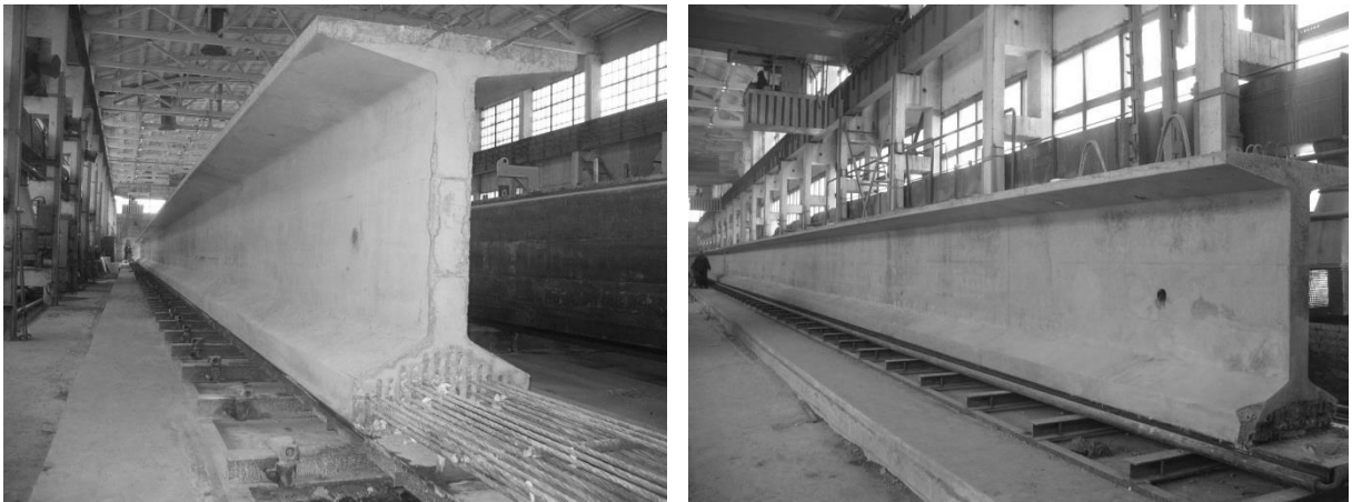
Рис. 2.18. Загальний вигляд балки МЗБК-160 при її виготовленні (а); загальний вигляд готової балки (б)
