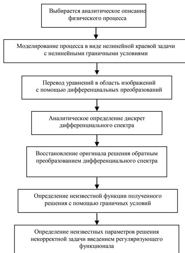
Рис. 2.2. Моделирование физических процессов и полей на основе дифференциальных преобразований нелинейных краевых задач
