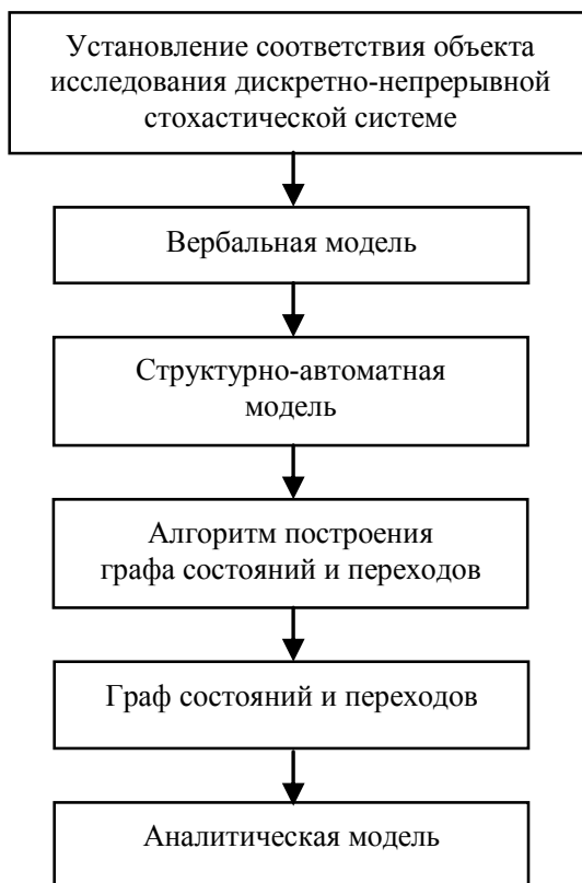
Рис. 3.12. Трансформация моделей объекта исследования при построении марковской модели по усовершенствованной технологии
