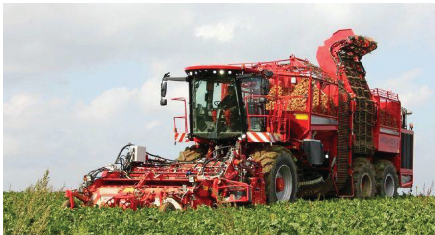
Рис. 5.14. Бункерный 6-рядный комбайн Holmer Terra Dos T3
