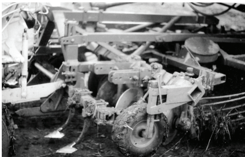
Рис. 7.12. Викопувально-очисні робочі органи типу «підкопувальна лапа — сферичний диск — турбіна /очищувач/»
