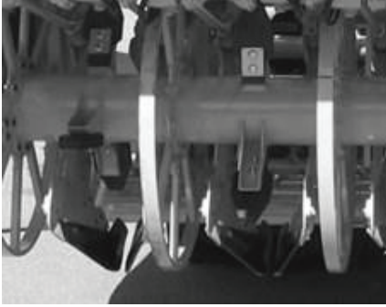
Рис. 5.7. Лемешкові викопувальні робочі органи фірми ROPA (зліва) і комбінований з дисковим коренезабірником фірми Stoll (справа)
