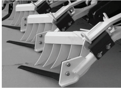
Рис. 5.6. Дообрізкач з пасивним полозковим копіром і пасивним ножем
