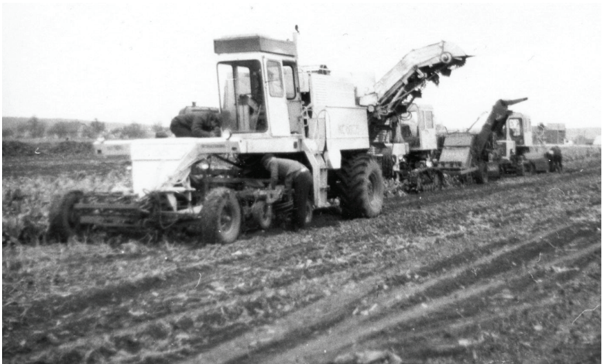
Рис. 5. Експериментальний комплекс восьмирядних збиральних машин: самохідна коренезбиральна; причіпна гичкозбиральна; причіпний до очищувач головок коренеплодів
