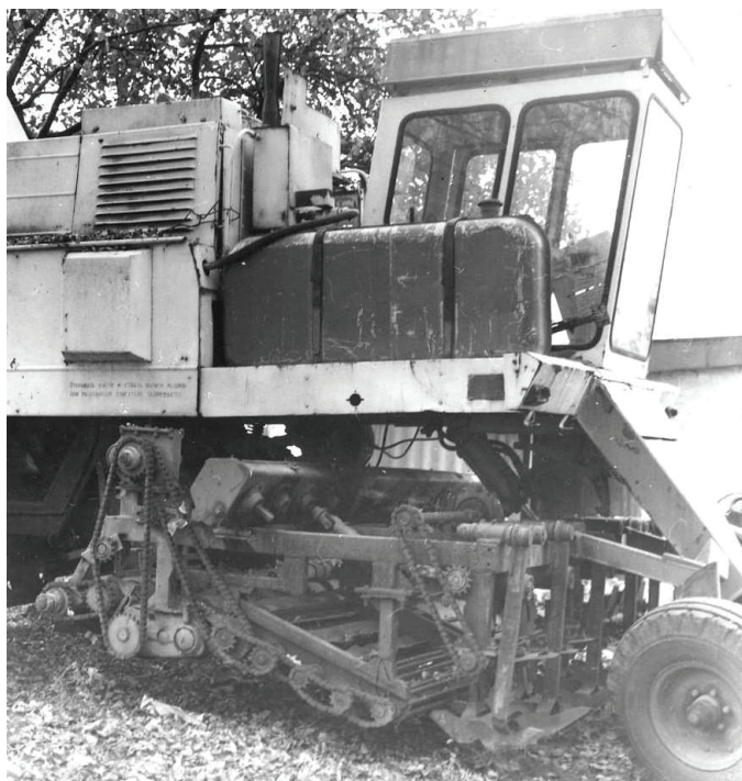
Рис. 7.2. Установка для дослідження процесу викопування коренеплодів за шириною міжрядь 30 см на базі коренезбиральної машини КС-6Б
