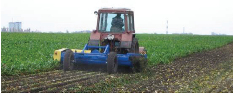
Рис. 5.22. Машина гичкозбиральна МГ-6 Уманьферммаш
