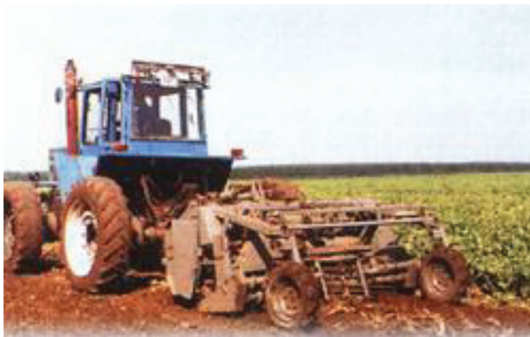
Рис. 5.18 Копач-валкоукладчик КВЦБ-1,2 БОРЕКС. в агрегаті з трактором ХТЗ-16031
