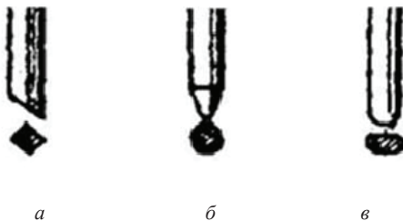
Рис. 2.8. Існуючі форми поперечного перерізу голчастих зубців ґрунтообробного знаряддя
