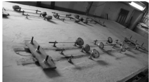
Рис.3.23.Загальний вид на конструкцію із розміщеними приладами: а) на боковій поверхні над опорою В та зони стиків, б) на плиті над опорою В та в зоні стиків
