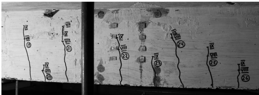
Рис. 3.42. Поширення тріщин на зовнішній грані збірної балки в середині прогону D-E по осі 1 дослідної конструкції
