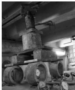
Рис.3.18. Візки навантаження: а) в середині прогону А-В, б) в середині прогону В-С.
