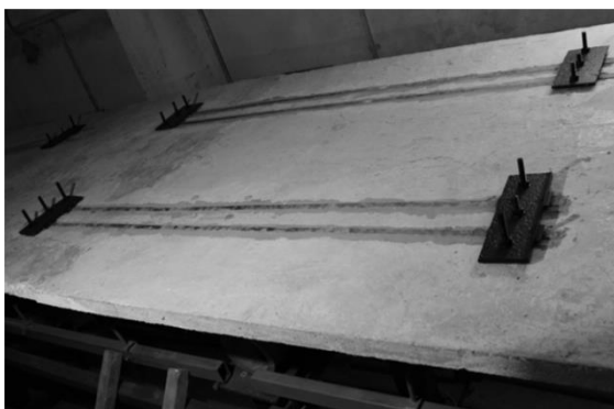
Рис.2.34. Розміщення неметалевої стрічкової арматури після об'єднання прямолінійної і криволінійної частин дослідної конструкції: а) над опорою С, б) над опорою D.
