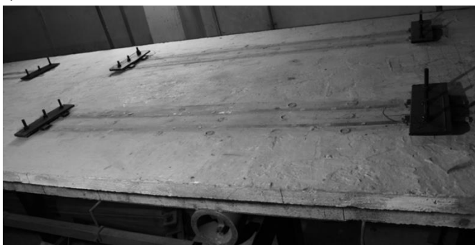
Рис. 2.28. Розміщена неметалева стрічкова арматура Sika carbodur типу S212 в над опорами та в зоні стиків дослідної конструкції: а) на прямолінійній частині, б) на криволінійній частині
