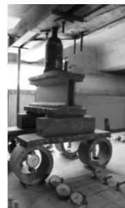
Рис.3.18. Візки навантаження: а) в середині прогону А-В, б) в середині прогону В-С.
