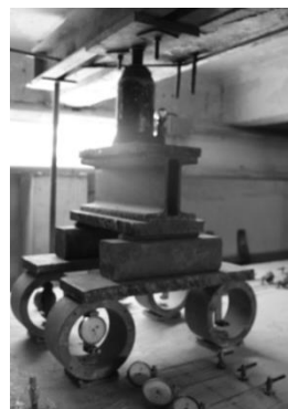
Рис.2.36 Навантаження дослідної конструкції: а) на прямолінійній частині, б) на криволінійній частині.
