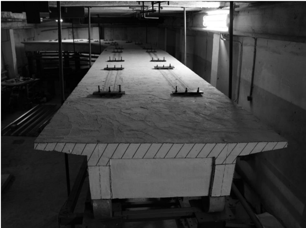
Рис.2.35. Вид шестипрогової нерозрізної дослідної конструкції двобалкової прогонової будови мосту для складних умов будівництва
