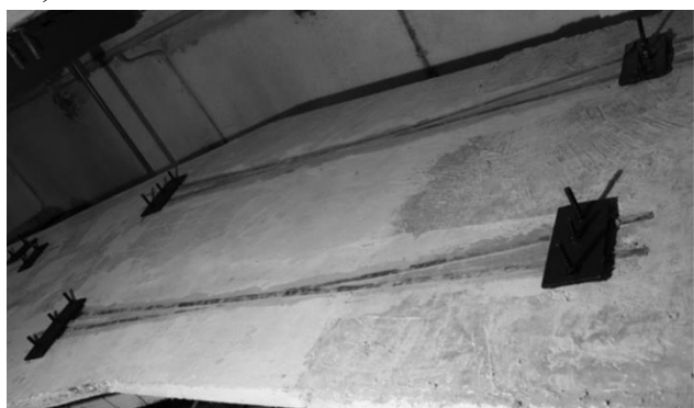
Рис.2.34. Розміщення неметалевої стрічкової арматури після об'єднання прямолінійної і криволінійної частин дослідної конструкції: а) над опорою С, б) над опорою D.
