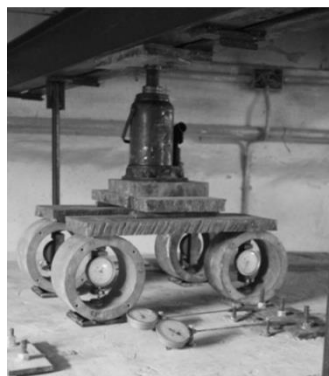
Рис.2.36 Навантаження дослідної конструкції: а) на прямолінійній частині, б) на криволінійній частині.
