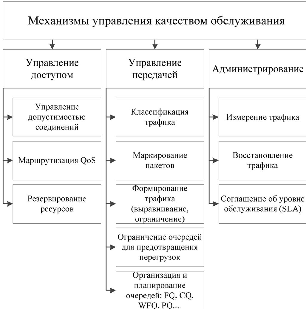
Рис. 3.1. Классификация механизмов управления качеством обслуживания
