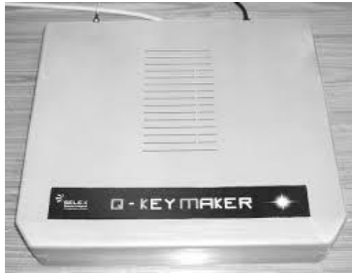
Рис. 1.7. Генератор квантових ключів Q-Key maker [110]
