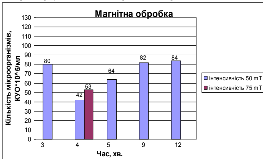
Рис.1. Вплив магнітної обробки на кількість живих мікроорганізмів в залежності від часу обробки стічної води дріжджового виробництва «Стиролбіотех».
