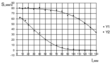
Рис.1. Зависимость скорости подачи обрабатываемого материала относительно струи от расстояния его до сопла
