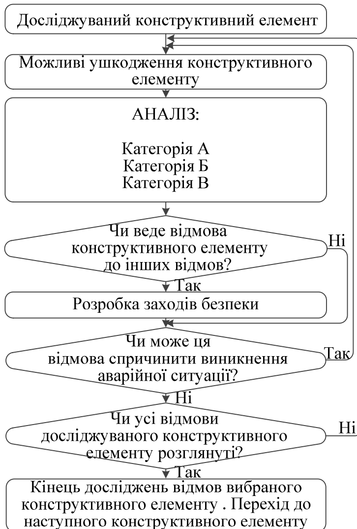
Рис. 3.3. Дерево відмови конструктивного елемента
