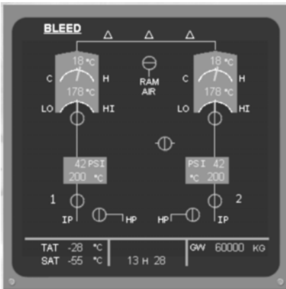
Рис. 12.13. Відображення інформації від системи підготовки повітря А-320
