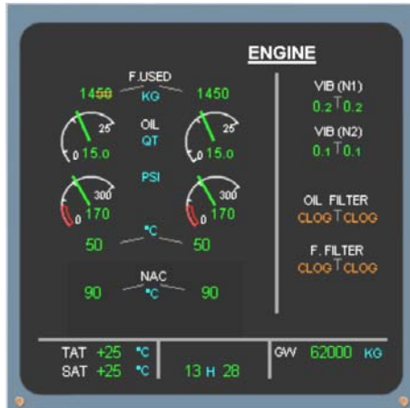
Рис. 12.3. Відображення параметрів роботи силової установки на ECAM
