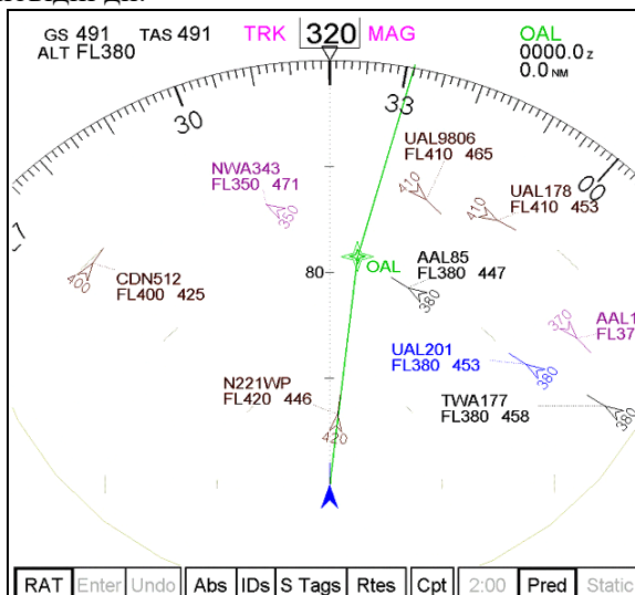
Рис. 4.7. Інформація в режимі ATSAW, відображена на бортовому індикаторі повітряної ситуації CDTI
