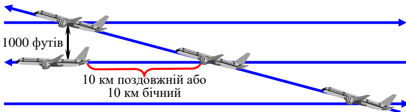
Рис. 6.19. Мінімуми ешелонування під час перетинання рівня на попутних треках у ТМА з використанням АС КРР
