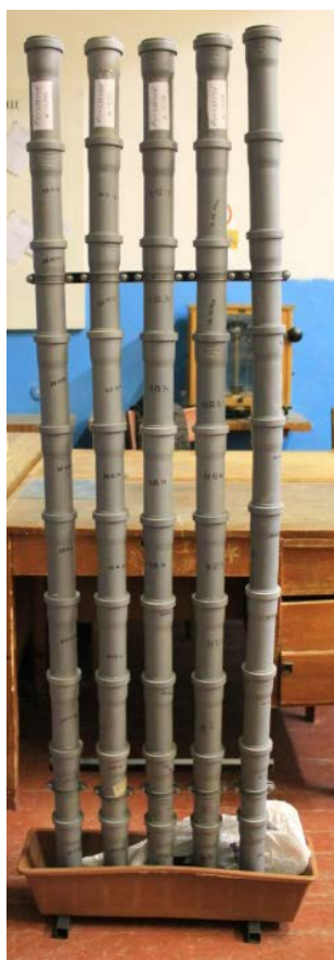
Рис. 2.4 Етапи проведення лабораторних досліджень вологісного режиму ущільненого суглинку дорожнього насипу: а – ручна трамбівка для ущільнення ґрунту; б – металева стійка для розташування труб з ущільненим глинистим ґрунтом; в, г – пластмасові труби заповнені ущільненим дослідним ґрунтом
