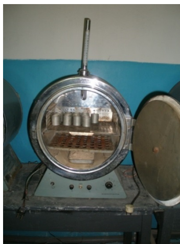
Рис. 2.2 Обладнання для визначення фізичних властивостей глинистого ґрунту а – сушильна шафа; б – технічні ваги; в – конус А.М. Васильєва для визначення вологості на межі текучості глинистого ґрунту
