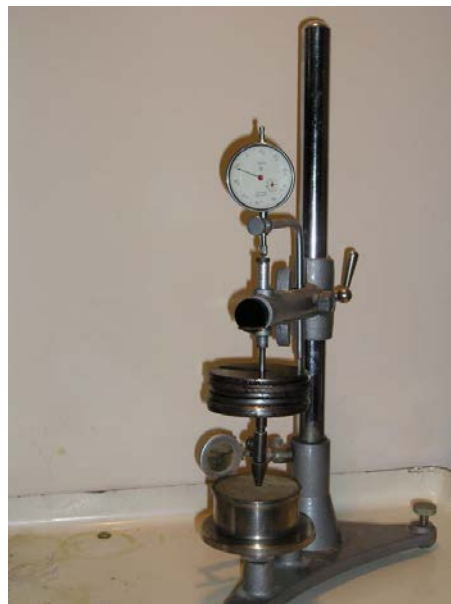
Рис. 4.3 Лабораторне обладнання для визначення механічних характеристик ґрунту: а – компресійний прилад; б – лабораторний пенетрометр; в – прилад одноплощинного зрушення
