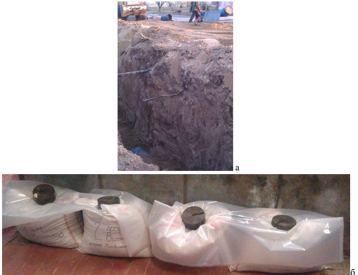
Рис. 2.1 Відбирання та зберігання дослідного суглинку: а – відбирання дослідного суглинку з траншеї; б – зберігання дослідного суглинку в лабораторії ПолтНТУ
