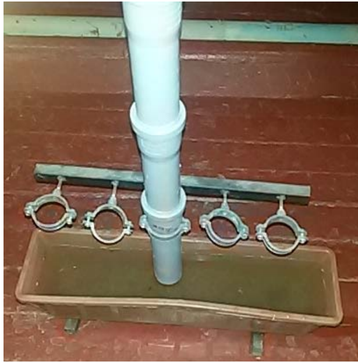
Рис. 3.3 Лоток, заповнений водою для дослідження можливого капілярного підняття вологи за дорожнім насипом
