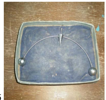
Рис. 2.2 Обладнання для визначення фізичних властивостей глинистого ґрунту а – сушильна шафа; б – технічні ваги; в – конус А.М. Васильєва для визначення вологості на межі текучості глинистого ґрунту
