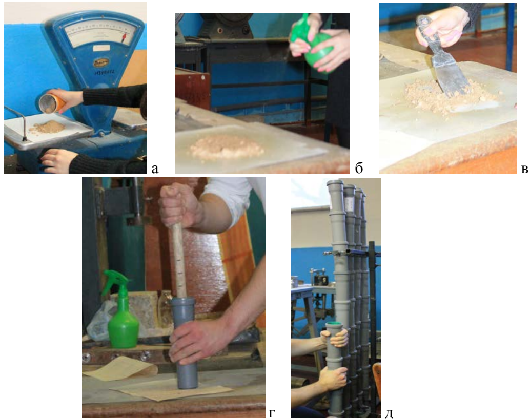
Рис. 1. Етапи проведення лабораторних досліджень вологісного режиму ущільненого суглинку дорожнього насипу: а – зважування порції ґрунту; б – дозволоження порції глинистого ґрунту до заданої величини w ; в – перемішування порції ґрунту для його рівномірного зволоження; г – пошарове (по 3 см) ущільнення кожної порції суглинку в трубі; д – монтування ланок труб до загальної висоти
