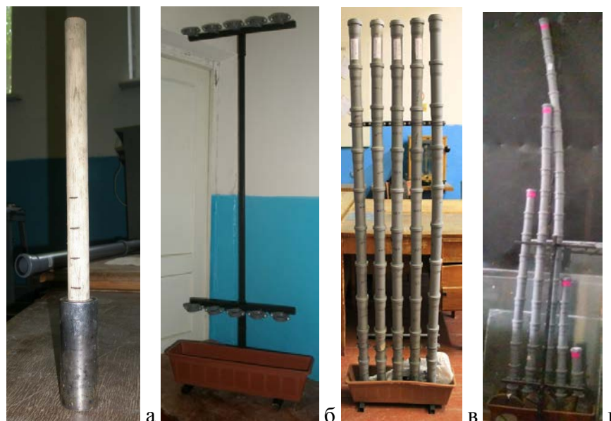
Рис. 2. Етапи лабораторних досліджень вологісного режиму ущільненого суглинку дорожнього насипу: а – трамбівка для ущільнення ґрунту; б – стійка для розташування труб з ущільненим ґрунтом; в, г – труби заповнені ущільненим ґрунтом
