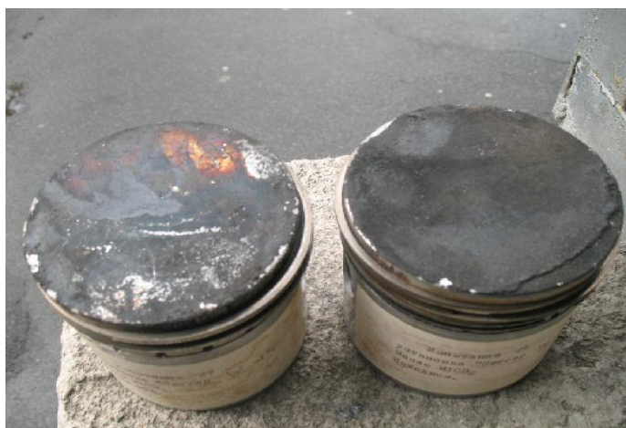
Рис. 4.1. Поршни после проведения испытания: контрольного образца масла (правый образец) и после ЭФВ на масло (левый образец).
