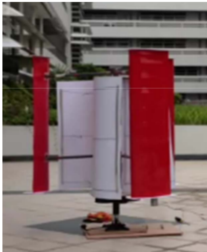
Рис. 2.4. Комбінований ротор з трьома прямими лопатями Дар'є та трилопатеvim ротором Савоніуса, розташованим всередині
