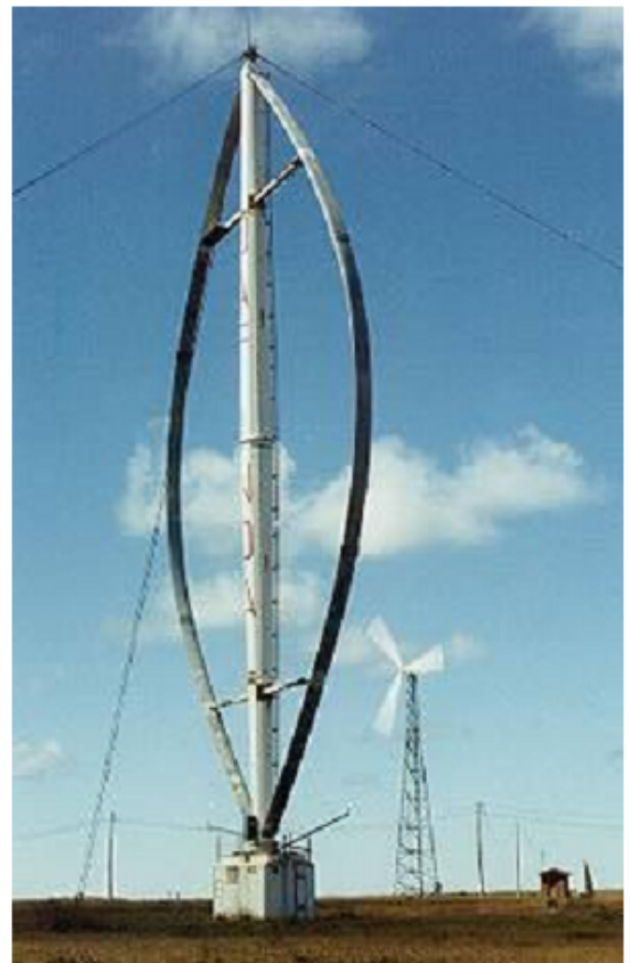
Рис. 1.5. Ротор Дар'є з лопатями, вигнутими по колу
