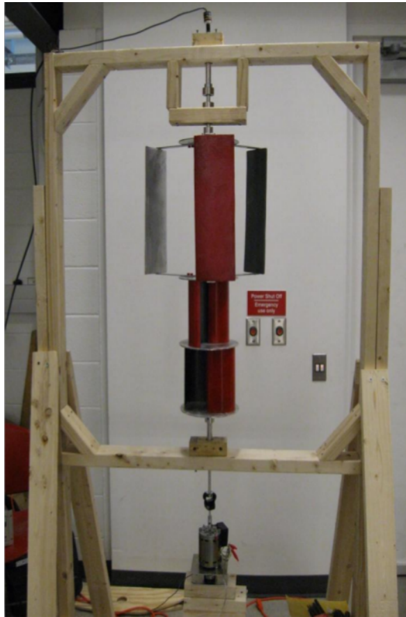
Рис. 2.6. Комбінований ротор з трьома лопатями Дар'є та двоступінчастим ротором Савоніуса з двома лопатями, рознесеними по фазі
