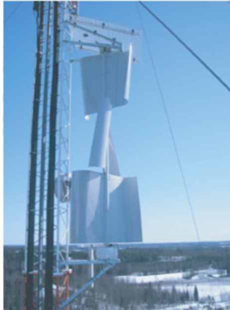
Рис. 2.1. Комбінований ротор з двоступінчастим ротором Савоніуса з двома лопатями, рознесеними по фазі та дволопатеvim ротором Дар'є
