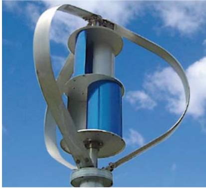
Рис. 2.3. Комбінований ротор з трьома дугоподібними лопатями Дар'є та двоступінчастим ротором Савоніуса з двома лопатями, рознесеними по фазі
