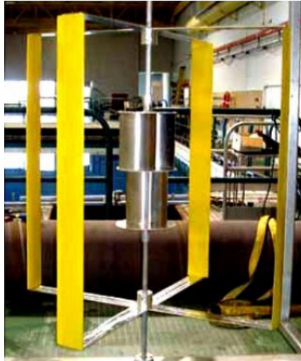
Рис. 2.8. Комбінований ротор з чотирма лопатями Дар'є та двоступінчастим ротором Савоніуса (розташованим всередині) з двома лопатями, рознесеними по фазі
