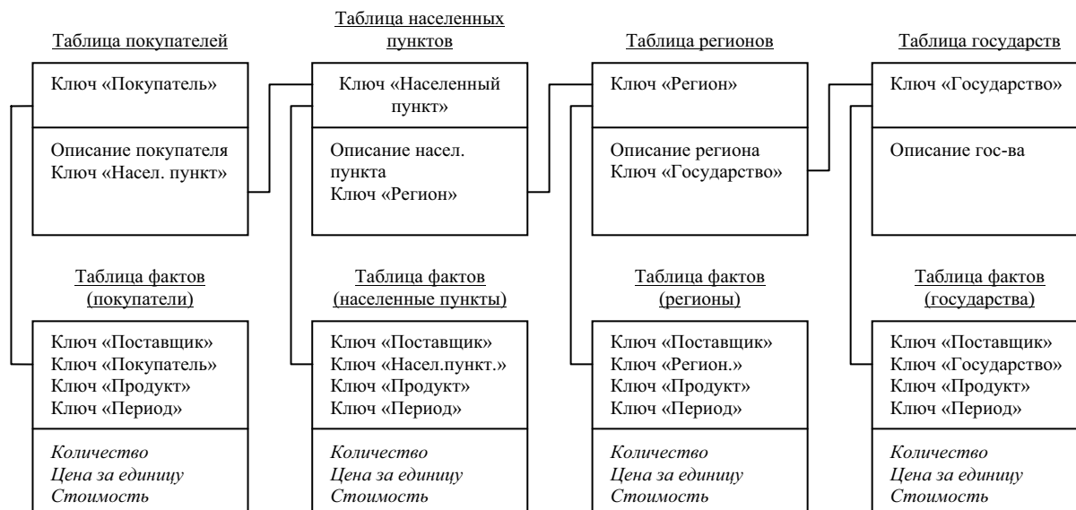
Рис. 5 Пример схемы «снежинки» (фрагмент для одного измерения)
