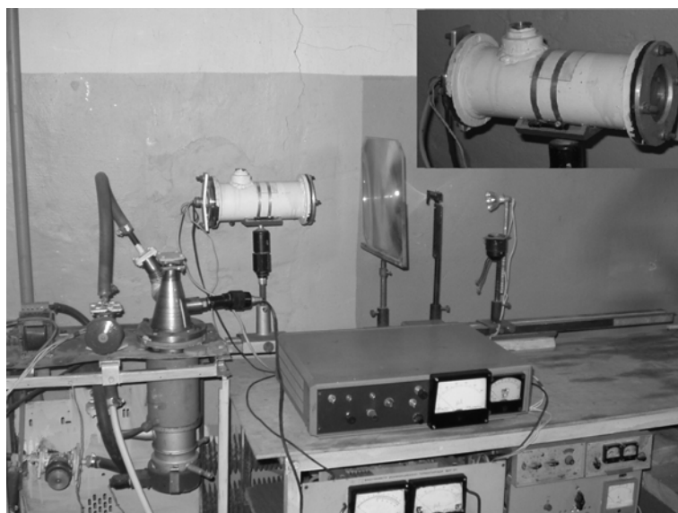
Рис. 1 Стенд для измерения температурных колебаний фотопреобразователей
