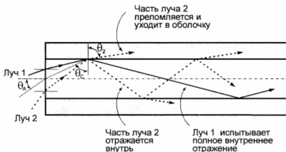
Рис.1 Распространение излучения в оптическом волокне
