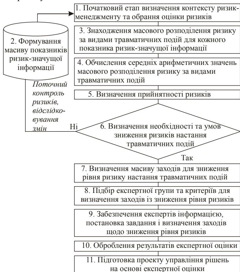
Рис. Алгоритм прийняття управлінських рішень на основі комбінованого методу оцінки ризику виробничого травматизму
