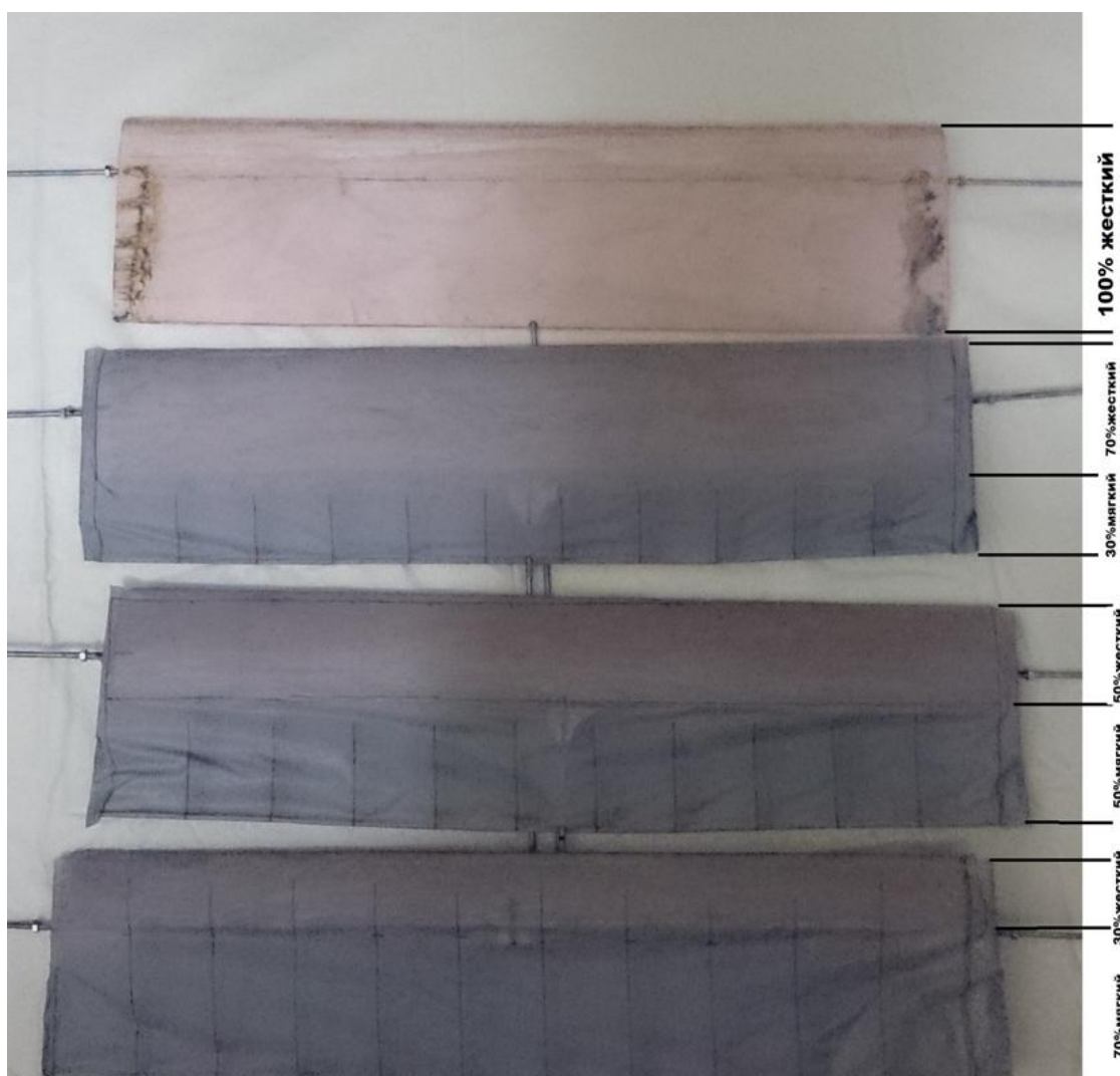
Рис. 3.2. Экспериментальные модели комбинированного крыла
