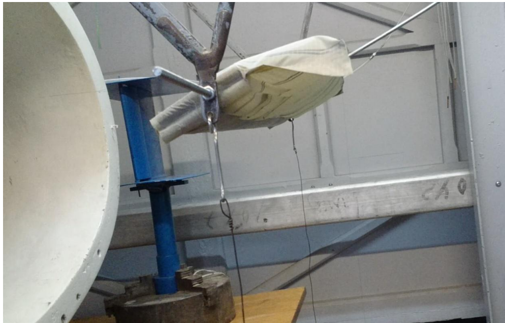
Рис. 3.10. Крыло 30% жесткое и 70% мягкое при наддуве \alpha = 32^\circ
