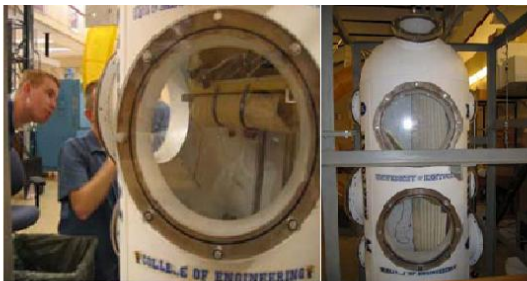
Рис. 1.20. Испытание надува BIG BLUE 3 в вакууме.
