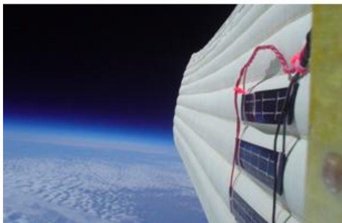
Рис. 1.14. Испытание надувного крыла на больших высотах.
