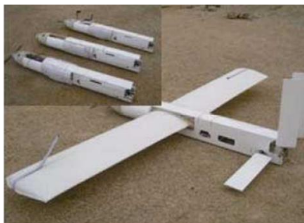
Рис. 1.12. Самолет с надувными крыльями в упакованном и распакованном виде.
