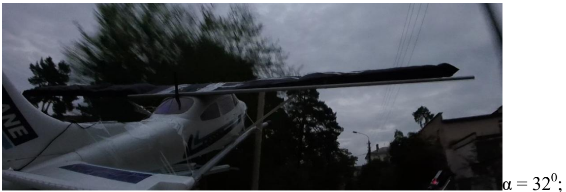
Рис. 3.40. Деформации наддуваемого крыла с мягкой хвостовой частью.
