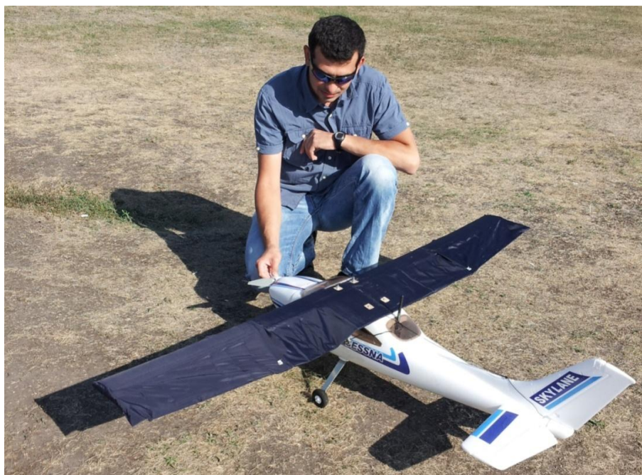
Рис. 3.31. Модель № 2. Cessna 172 с комбинированными крыльями, что состоит из 30% жесткой части и 70% мягкой надувной части.
