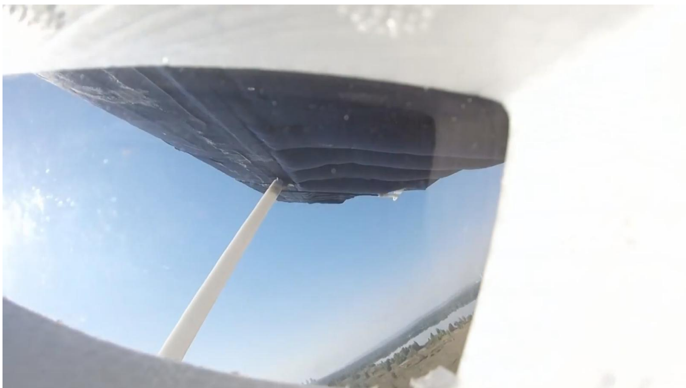
Рис. 3.34. Полет модели самолета Cessna 172 с комбинированным крылом \alpha \approx 45^\circ .
