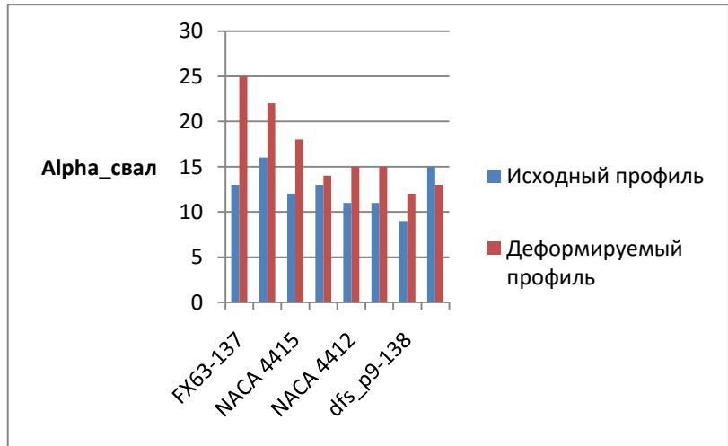
Рис. 5.19. Крыло бесконечного размаха. Влияние деформации на критический угол атаки профиля.
