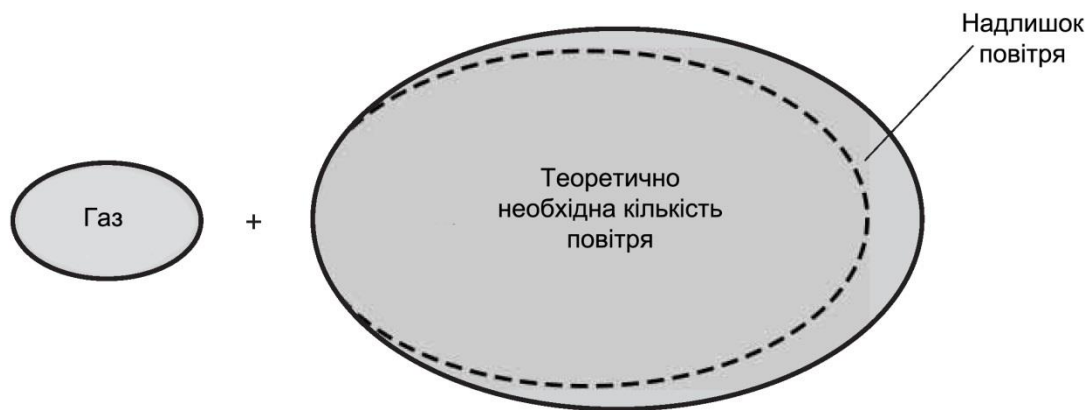
Рис. 2. Схема утворення надлишкового повітря в процесі горіння
