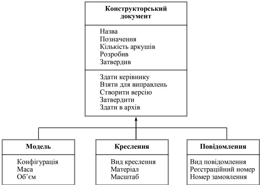
Рис. 3.6. Приклад відношень узагальнення на діаграмі класів (вказано не всі підкласи та атрибути)
