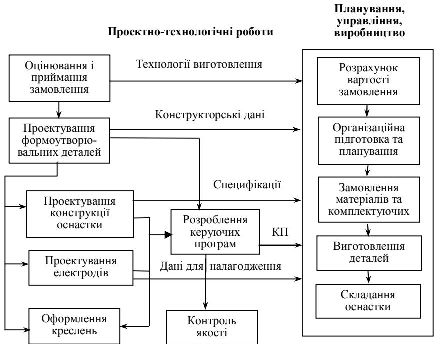
Рис. 4.14. Інтегроване виконання робіт під час проектування та виготовлення ФО та ФІ з використанням CAD/CAM-системи Cimatron E
