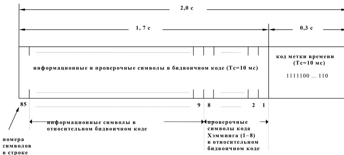
Рис. 6.3. Структура информационной строки сигнала ГЛОНАСС
