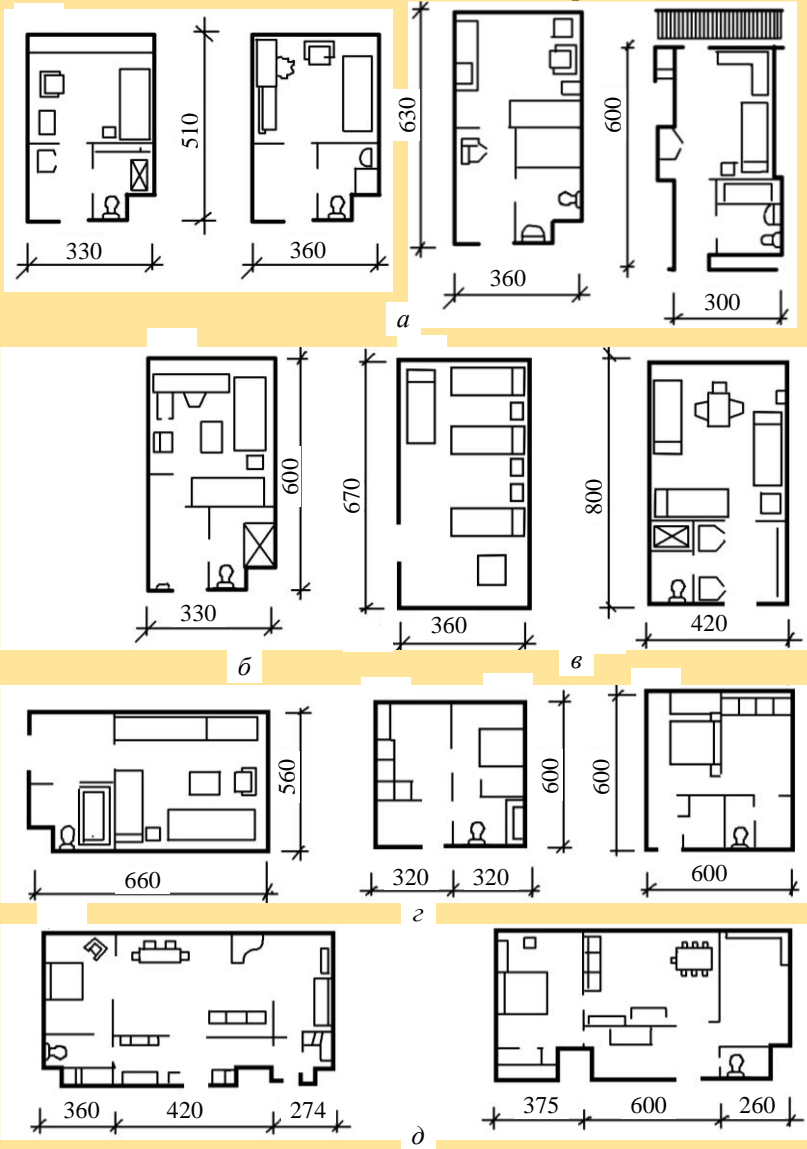
Рис. Д.11.10. Планувальна організація готельних номерів: а – одномісний; б – двомісний; в – три- і чотиримісний; г – двокімнатний люкс; д – номери-апартаменти
