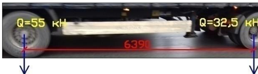
Рис. В3 Геометричні параметри та розподіл колісних навантажень від автомобіля DAF-FT XF95 + напівпричеп Kögel – GN-24 на першій та другій осі
