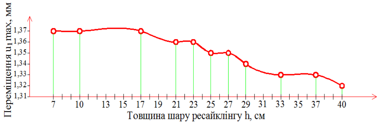
Рис. 4.35 Графік залежності максимального за абсолютним значенням вертикального переміщення u_{1 \max} від товщини шару бетону із холодних сумішей на основі фрезерованого асфальтобетону
