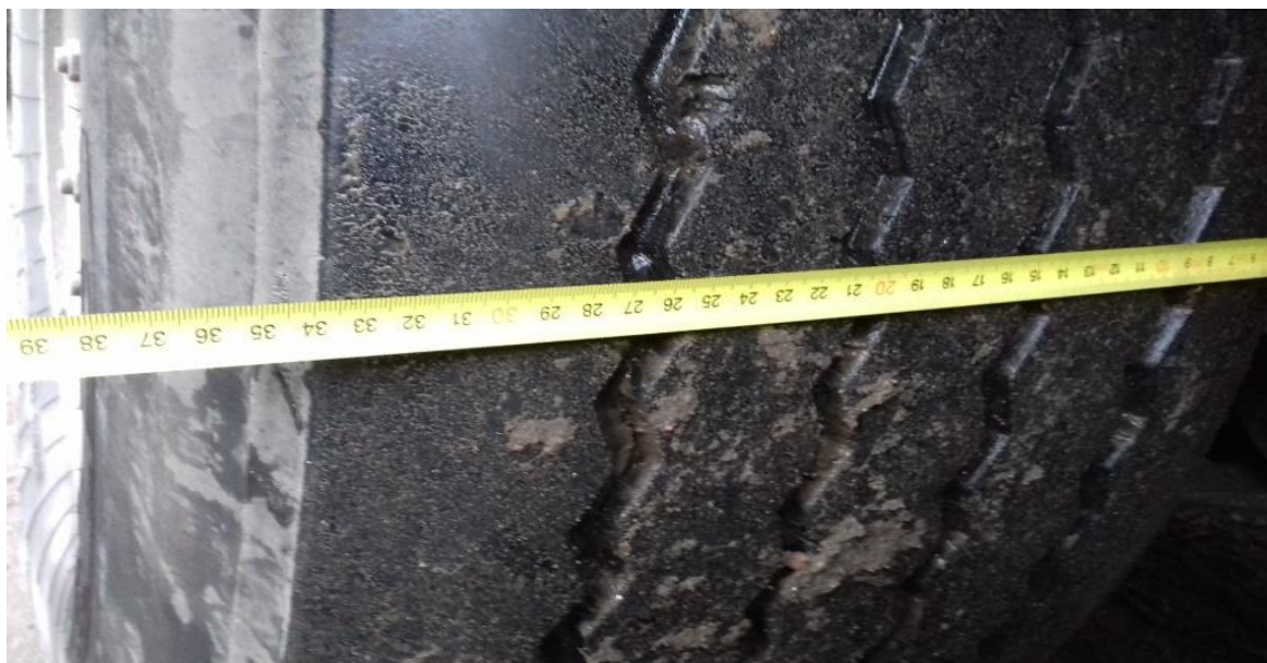
Рис. В4 Виміряна ширина пневматика колеса розрахункового автопоїзда DAF-FT XF95 + напівпричеп Kögel – GN-24
