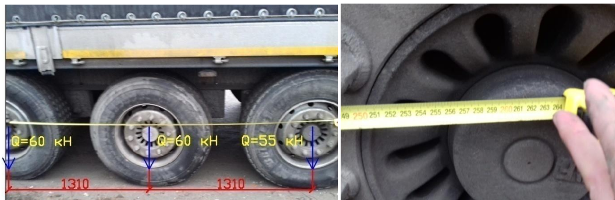
Рис. В1 Геометричні параметри та розподіл колісних навантажень від автомобіля DAF-FT XF95 + напівпричеп Kögel – GN-24 на задньому візку
