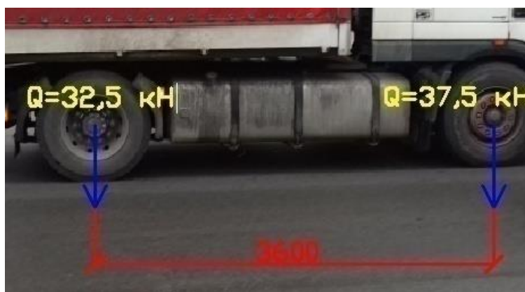
Рис. В2 Геометричні параметри та розподіл колісних навантажень від автомобіля DAF-FT XF95 + напівпричеп Kögel – GN-24 на першій та другій осі
