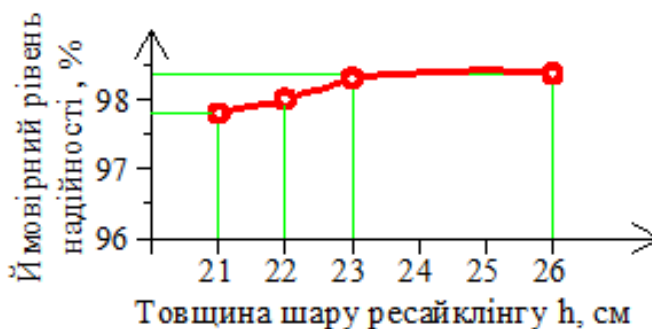
Рис. 4.6 Графік залежності ймовірного рівня надійності конструкції дорожнього одягу від товщини шару ресайклінгу h при осьовому навантаженні Q=130 кН
