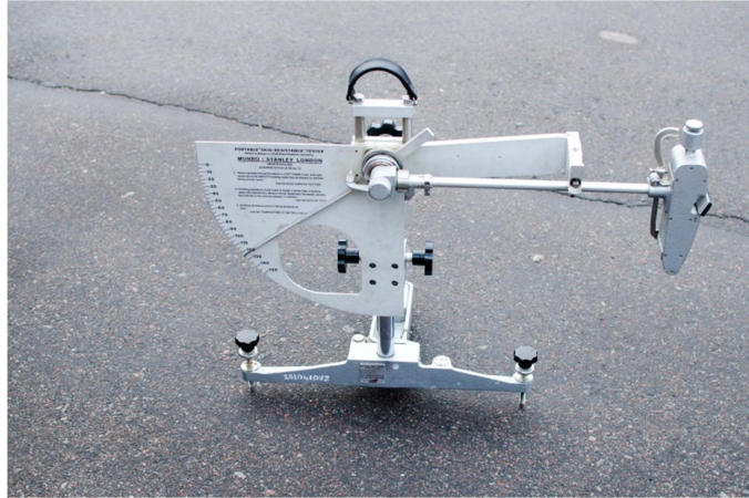
Рис. 4.4. Портативний маятниковий прилад МП-3
