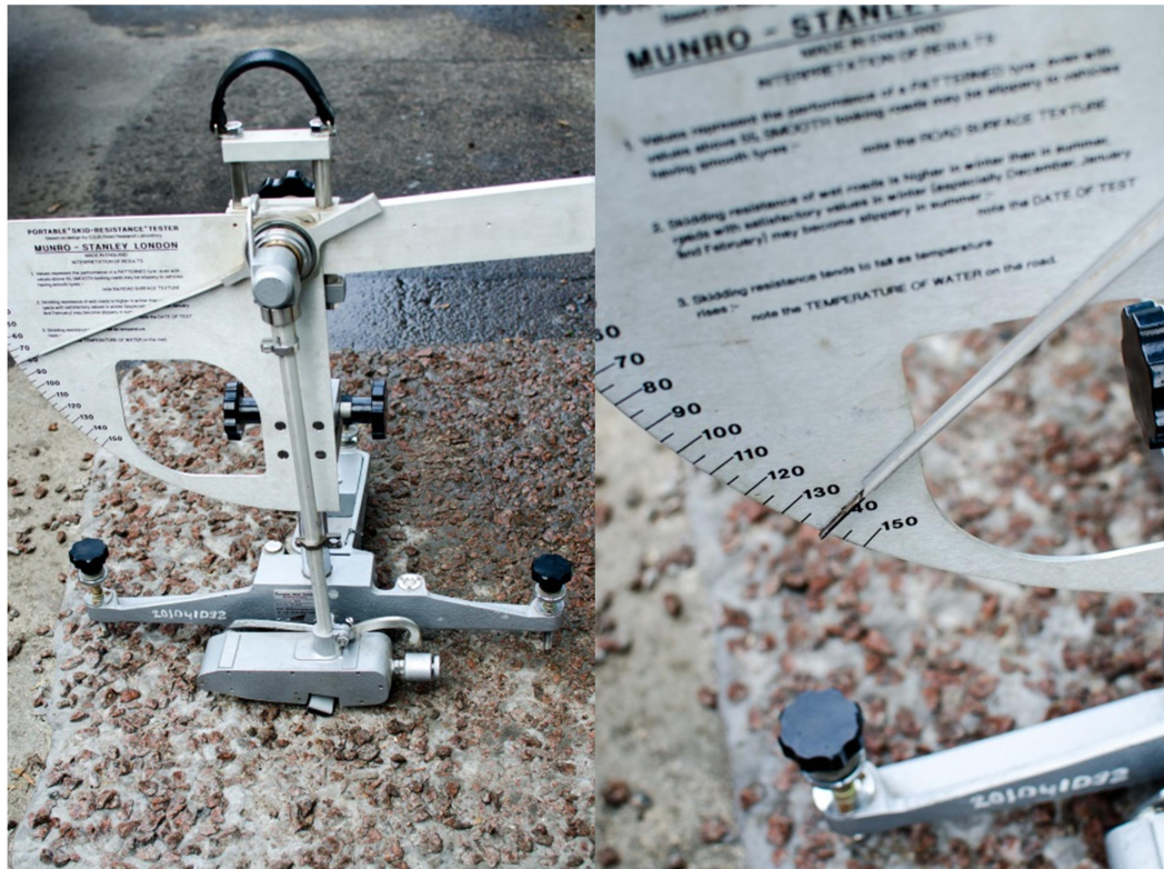
Рис. 4.10. Визначення коефіцієнту зчеплення портативним маятниковим приладом МП-3
