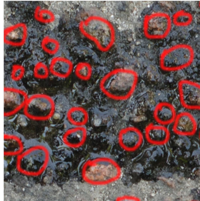
Рис. 2.10. Площа контакту протектору шини з частками кам'яного матеріалу
