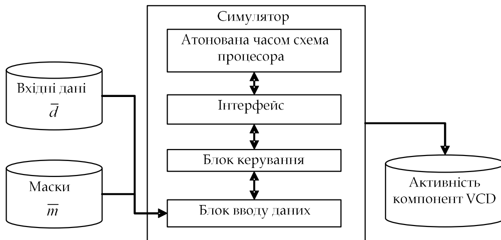
Рис. 4.9. Структура системи тестування процесорів шифрування даних у МП
