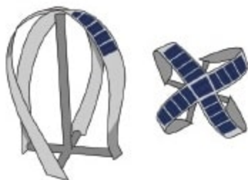
Рис. 1. Ефективні лопасті сонячно-вітрової установки
