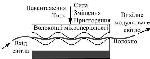
Рис. 7.30. Волоконнооптичний сенсор нерівностей
