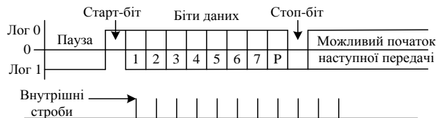
Рис. 8.21. Формат асинхронного передавання даних
