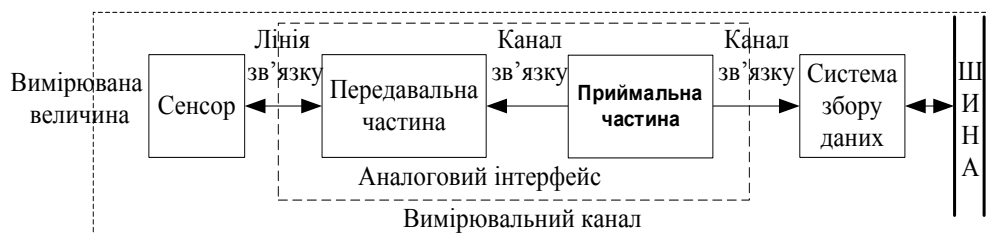
Рис. 8.1. Структура вимірювального каналу з аналоговим інтерфейсом
