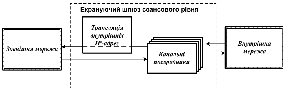
Рис. 10.38. Схема функціонування шлюзу сеансового рівня
