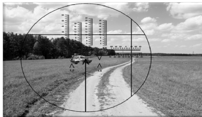
Рис. 2. Зображення сітки прицілу типу ОП4М на екран
