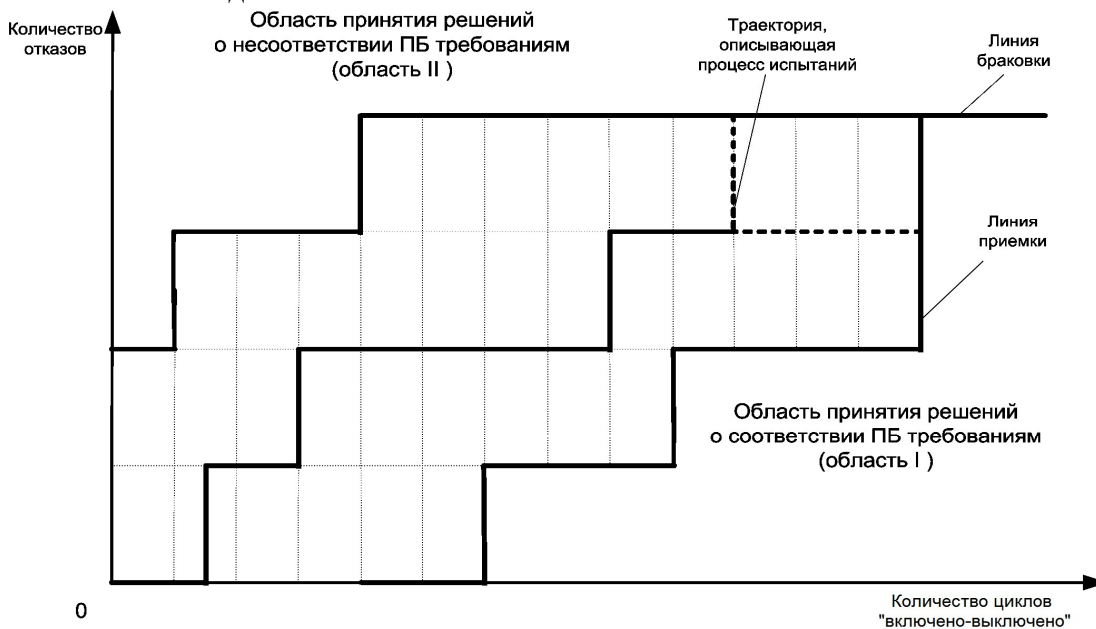
Рис.1. Графическое представление процесса проведения усеченных последовательных испытаний РЭС ЗРК по показателю “вероятность безотказного включения”
