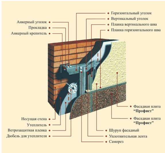
Рис. 1.6. Конструкція і вигляд фасадної системи
