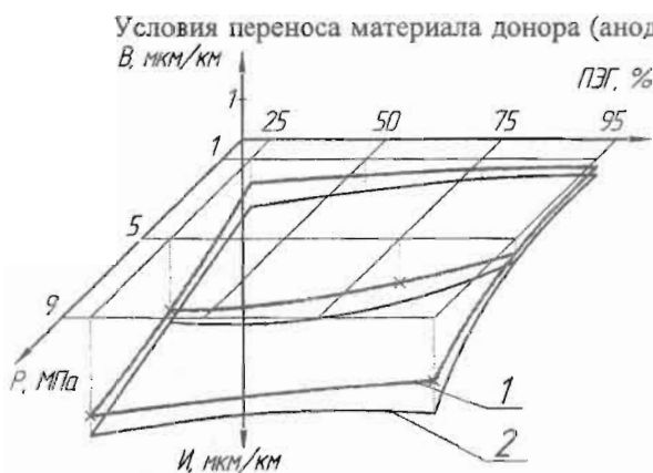
Рис. 1 – Трибологические параметры Ст 45 (М) по стеклу от нагрузки и концентрации ПЭГ: 1 – в открытой системе; 2 – с принудительной прокачкой воздуха
