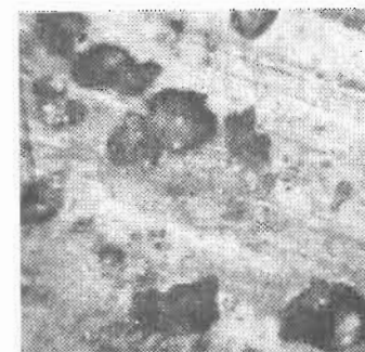
Рис. 2. Конгломераты продуктов износа, попавшие в зону трения. Процесс трения стали 45 по стеклу при P=1 МПа, V=0,1 м/с в динамике ( \times 125 )
