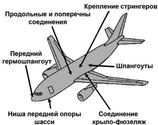
Рис. 6.6. Восприимчивые к MSD критические места конструкции для A300
