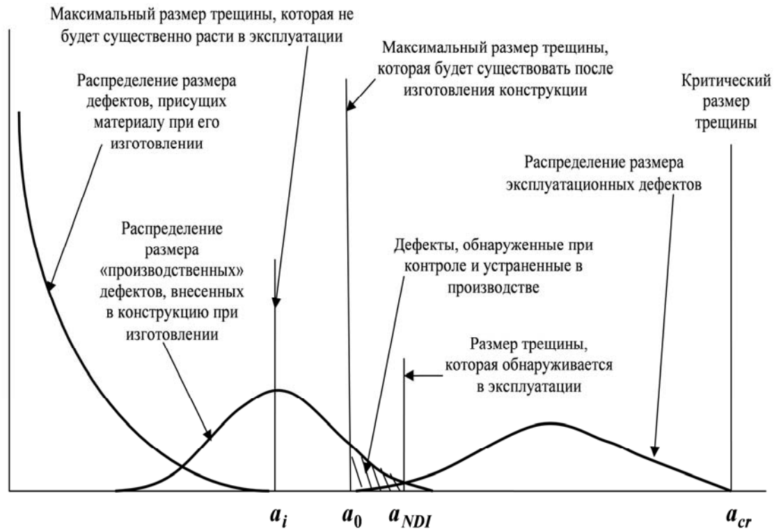
Рис. 8.1. Схематическое представление характерных размеров дефектов в конструкциях при их изготовлении и эксплуатации
