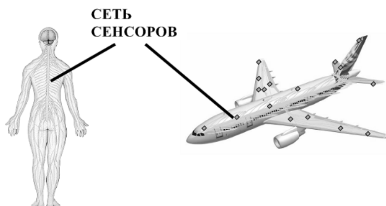
Рис. 9.1. Схематическое представление системы сенсоров в конструкции самолета в виде нервной системы человека
