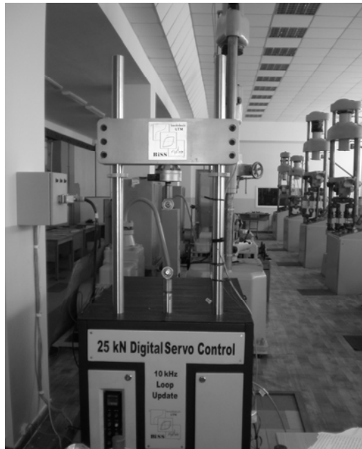
Рис.7.4. Сервогидравлическая испытательная машина в лаборатории кафедры конструкции летательных аппаратов Национального авиационного университета
