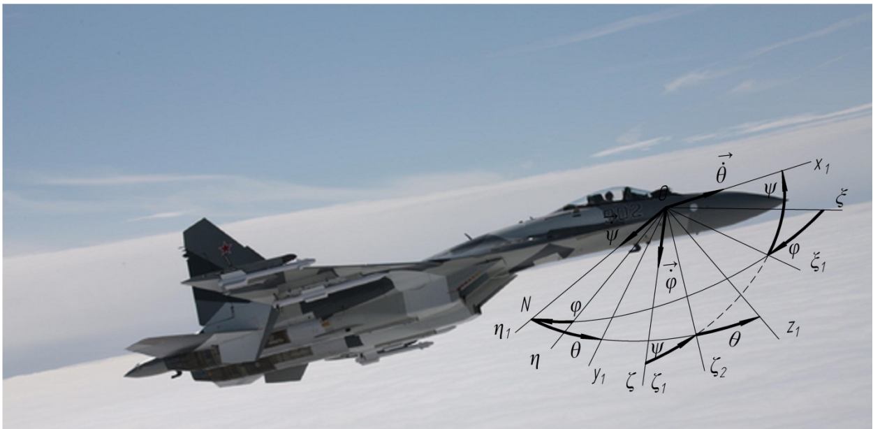
Рис. 5.4. Схема кутів повороту фюзеляжу ЛА: \varphi - кут ристання, \psi - кут тангажа, \theta - кут крена
