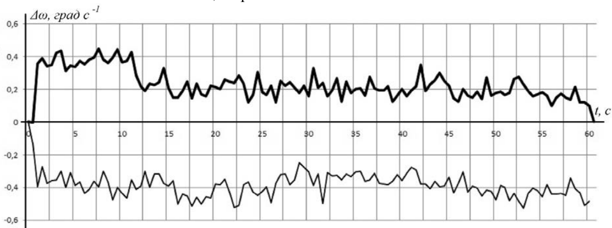
Рис. 4.16. Вихідний сигнал ДУСУ при \varphi = 45^\circ , гіроагрегат виключений: тонка лінія – \theta = 0^\circ ; жирна лінія – \theta = 17^\circ
