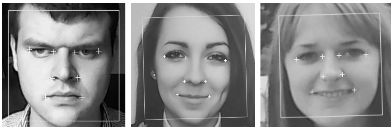
а) б) в) Рис. 5. Выходные изображения с локализованными контрольными точками
