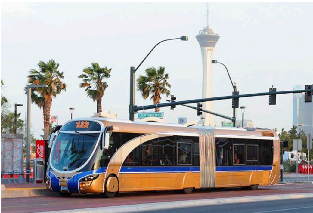
Рисунок 4.40 – Сучасний низькопільний автобус
