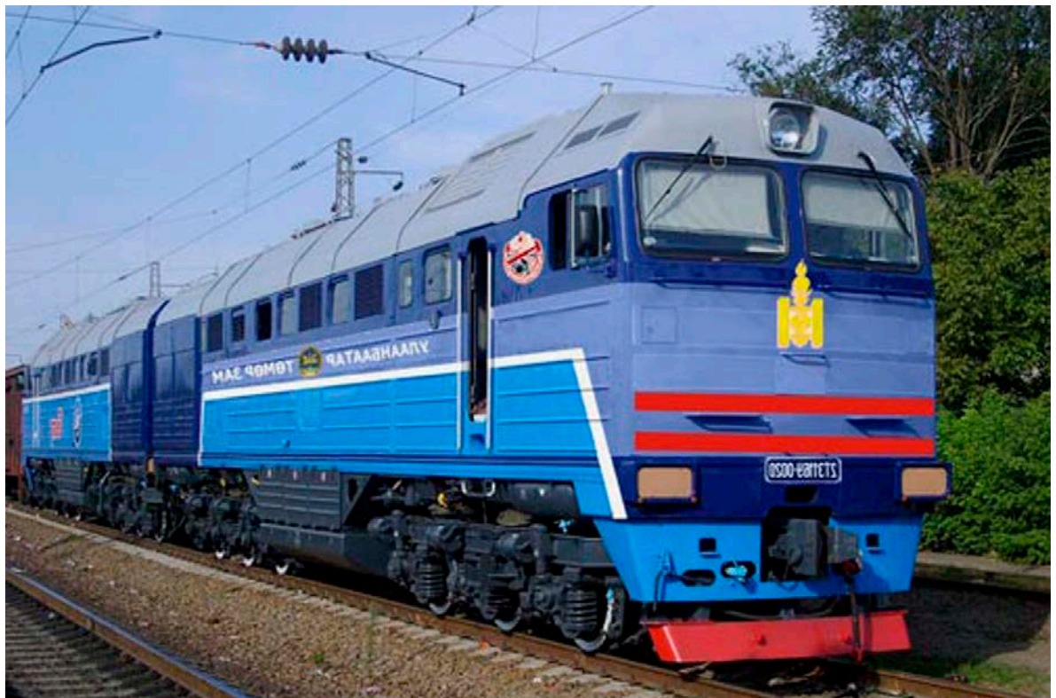
Рисунок 4.21 – Магістральний тепловоз 2ТЭ116УМ від «Луганськтепловоз»
