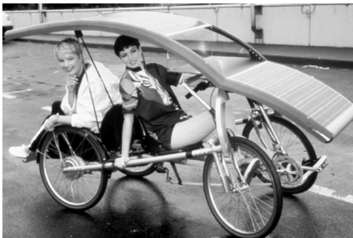
Рисунок 86 – «HALF-Mobil». Легкий транспортний засіб з використанням мускульної сили, сонячної та електричної енергій. Автор проекту – професор, д-р Е.Шарновски. Університет мистецтв і дизайну Галле-Бург Гібихенштайн, Німеччина. 1995 р.
