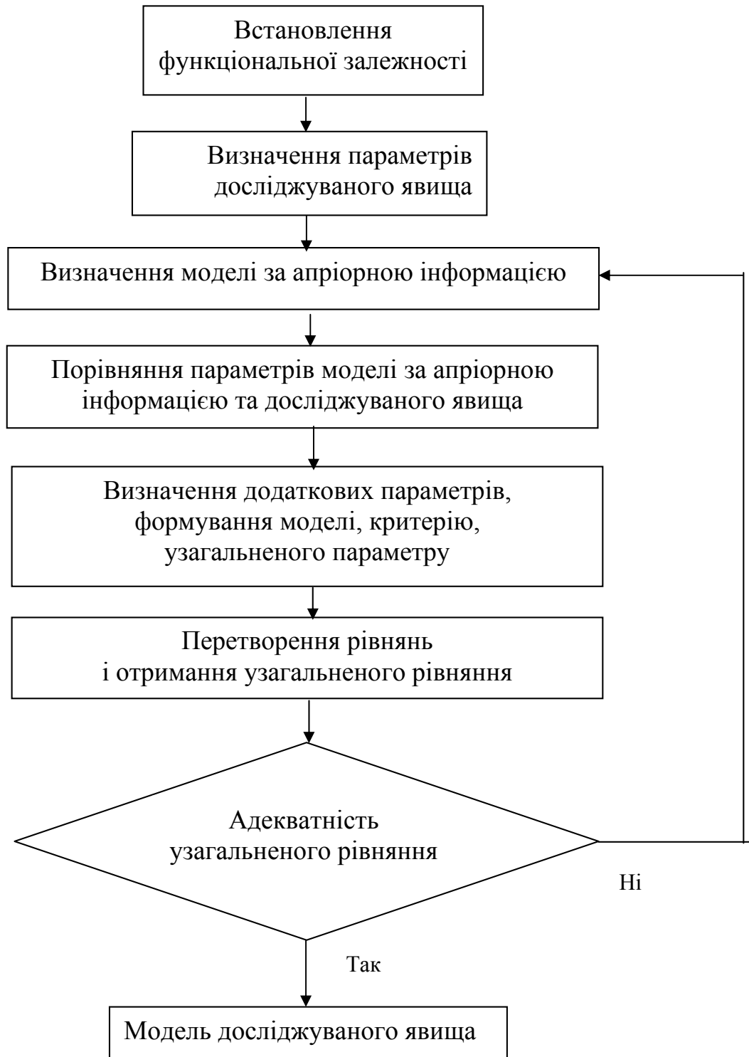
Рис. 2.1. Блок-схема встановлення функціональної залежності між параметрами
