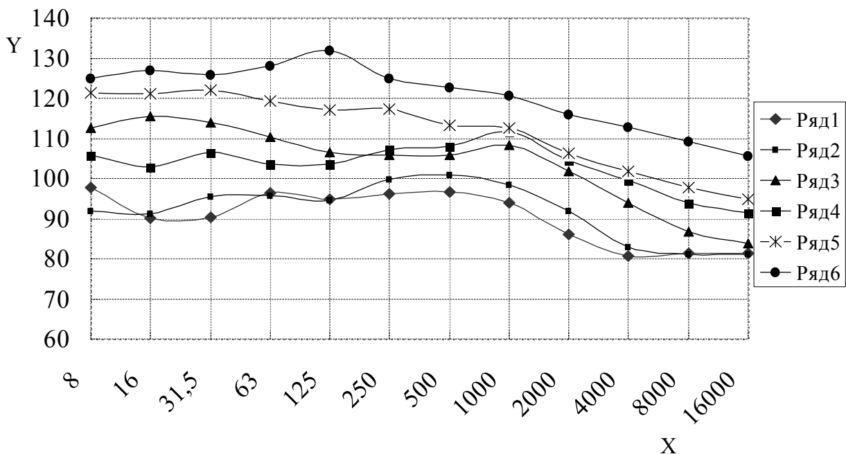
Рисунок 4.14. РЗТ (Y, дБ) в октавних смугах частот (X, Гц) для «рваного» отвору з F_{\text{від}} = 0,486 при розгерметизації відсіку з різними початковими тисками газу в відсіку: Ряд 1 – P_{\text{над}} = 0,22 \times 10^5 Па, L_{\text{сум}} = 104,79 дБ; Ряд 2 – P_{\text{над}} = 0,4 \times 10^5 Па, L_{\text{сум}} = 106,83 дБ; Ряд 3 – P_{\text{над}} = 0,77 \times 10^5 Па, L_{\text{сум}} = 120,59 дБ; Ряд 4 – P_{\text{над}} = 1,26 \times 10^5 Па, L_{\text{сум}} = 117,2 дБ; Ряд 5 – P_{\text{над}} = 1,85 \times 10^5 Па, L_{\text{сум}} = 128,54 дБ; Ряд 6 – P_{\text{над}} = 3,01 \times 10^5 Па, L_{\text{сум}} = 136,12 дБ
