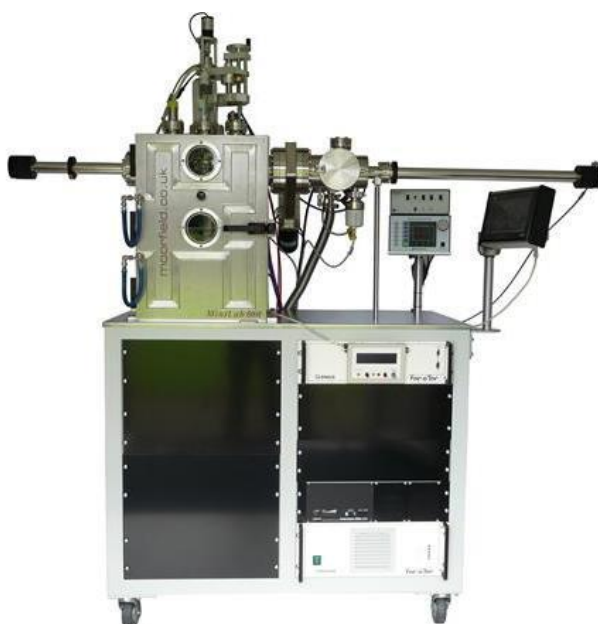
Рис. 3.1.3.1. Представлення обладнання для електронно-променевого осадження Moorfield, яке було використано для випаровування тонких плівок металів та оксидів металів. Діелектрик \text{HfO}_2 з високим значенням діелектричної проникності наносився на підкладку за допомогою електронно-променевої системи Moorfield [107]
