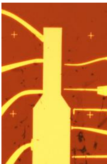
Рис. 3.1.3.3. Оптичні зображення вироблених електрооптичних модуляторів на основі графена. Оптичні зображення модулятора зроблені у режимі відбиття світла. Збільшення оптичного мікроскопу становить 50X
