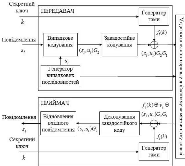
Рис. 1. Схема РПШ Міхалевича-Імаї
