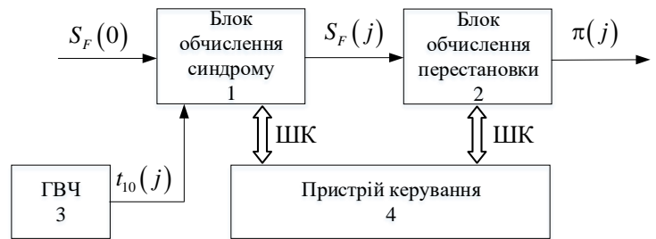
Рис. 1. Структурна схема пристрою формування випадкових послідовностей перестановок
