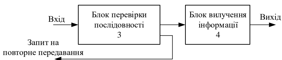
Рис. 3.3. Структурна схема блоку декодування ФКВД
