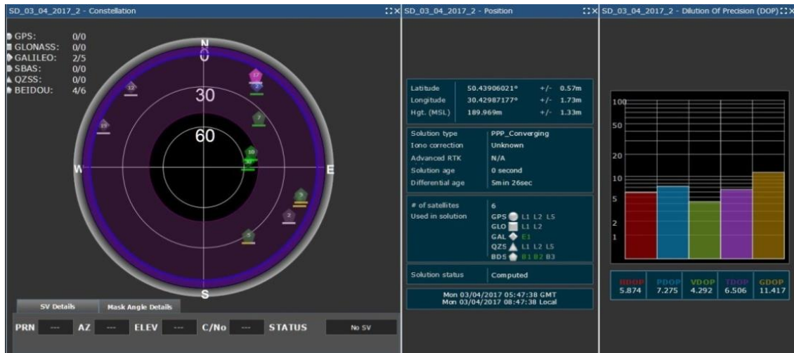
Рис. 4.28 – Діаграма видимості 2 супутників Galileo та 4 супутників BEIDOU та характеристики точності
