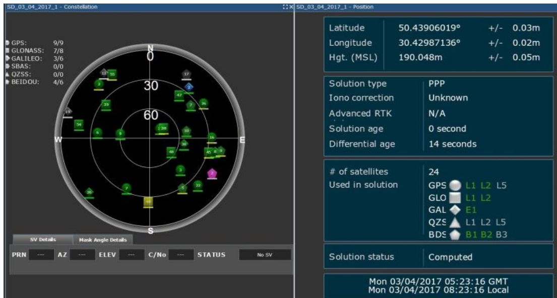
Рис. 4.21 – Діаграма видимості 24 супутників чотирьох систем та характеристики точності
