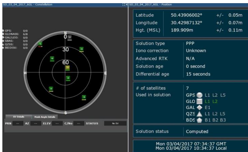
Рис. 4.24 – Діаграма видимості 7 супутників ГЛОНАСС та характеристики точності
