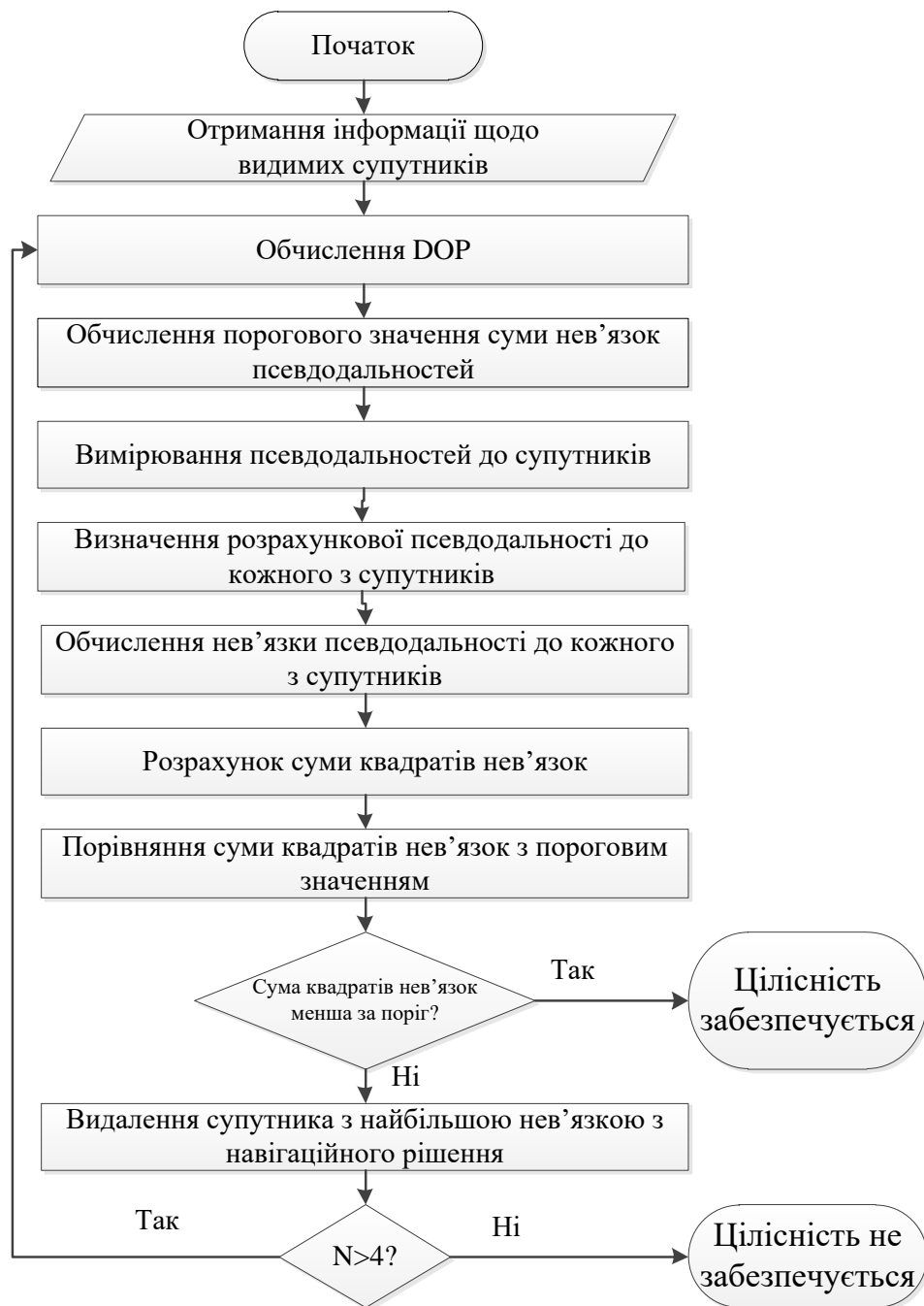
Рис. 2.6 – Схема алгоритму контролю цілісності навігаційного поля за умов відсутності надлишкових вимірювань
