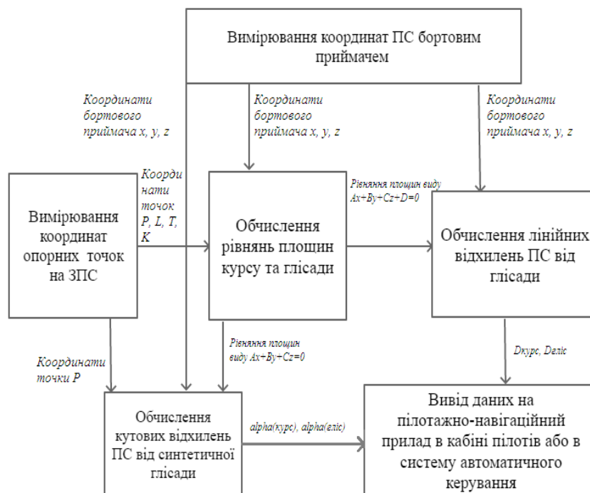
Рис. 2.1 – Структура узагальненого алгоритму процесу посадки
