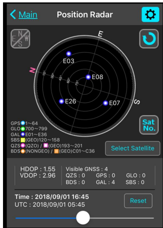
Рис. 5.7 – Сприятливий геометричний фактор при 4-х видимих супутниках
