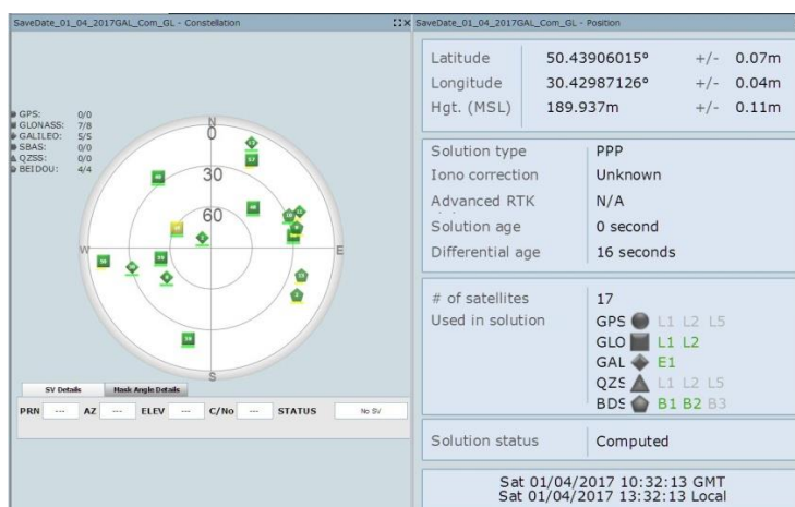
Рис. 4.26 – Діаграма видимості 7 супутників ГЛОНАСС, 5 – GALILEO, 4- BEIDOU та характеристики точності
