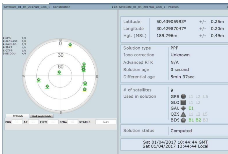
Рис 4.27 – Діаграма видимості 5 супутників Galileo та 4 супутників BEIDOU та характеристики точності
