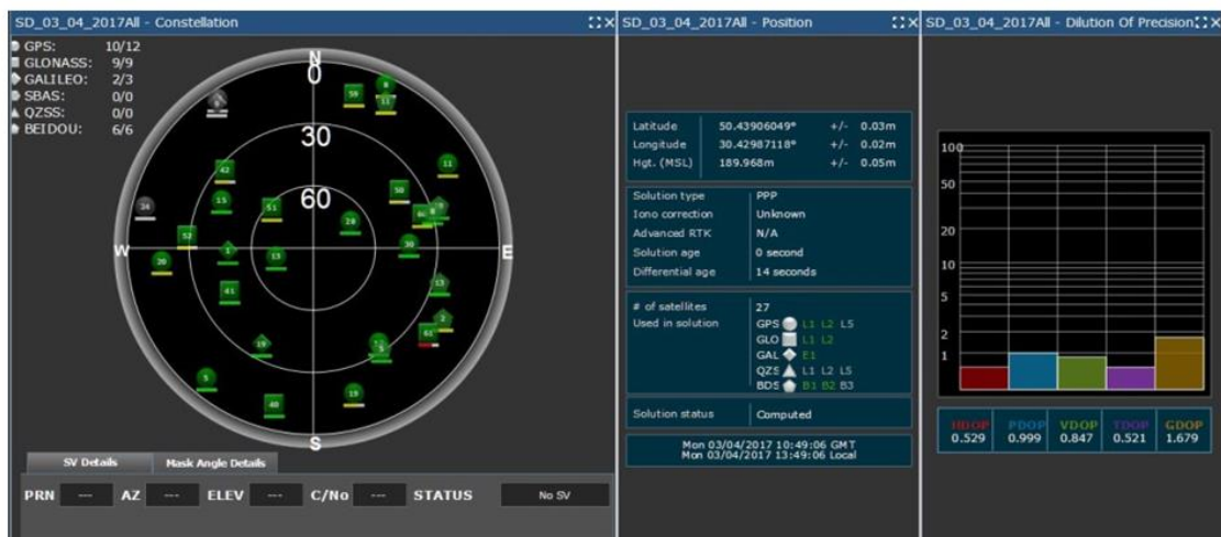
Рис. 4.22 - Діаграма видимості 27 супутників чотирьох систем та характеристики точності
