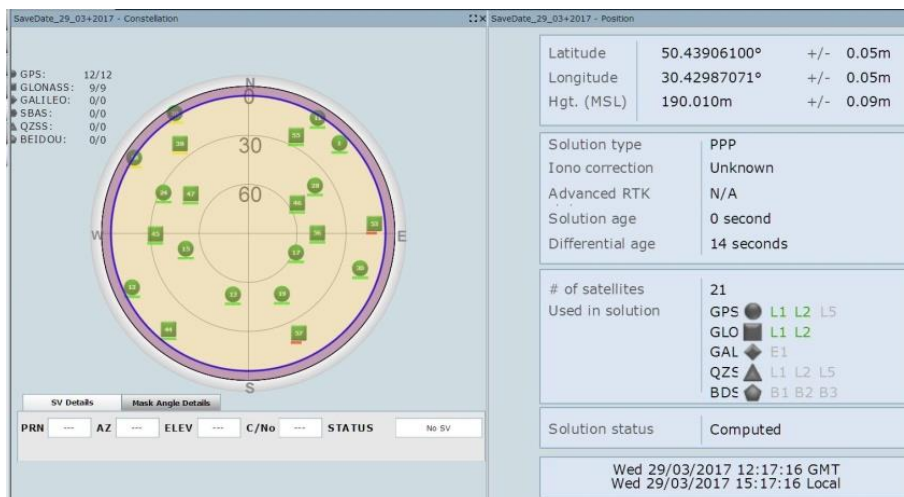
Рис. 4.25 – Діаграма видимості 12 супутників GPS, 9 - ГЛОНАСС та характеристики точності
