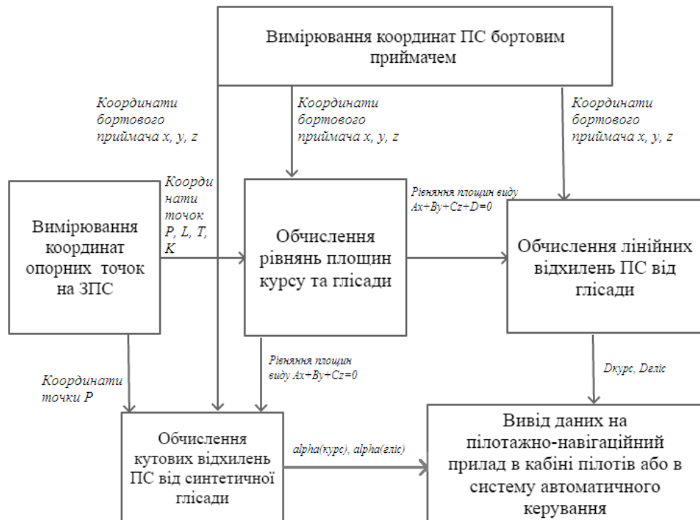
Рис. 2.3 - Структурна схема моделі наведення ПС на синтетичну глісаду
