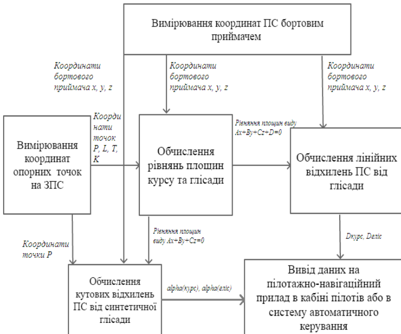
Рис. 1. Структурна схема моделі наведення ПС на синтетичну глісаду
