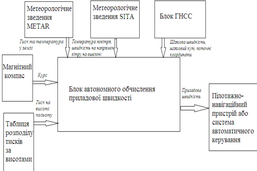
Рис. 4. Структурна схема моделі розрахунку приладової швидкості
