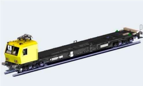
Рис. В. 1. Самохідна платформа пожежного аварійно-рятувального поїзда
