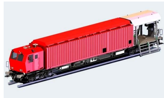
Рис. В.4. Самохідна платформа з рятувним модулем для надання медичної допомоги потерпілим
