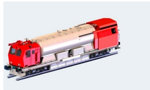
Рис.В.2. Цистерна модульного пожежного аварійно-рятувального поїзда
