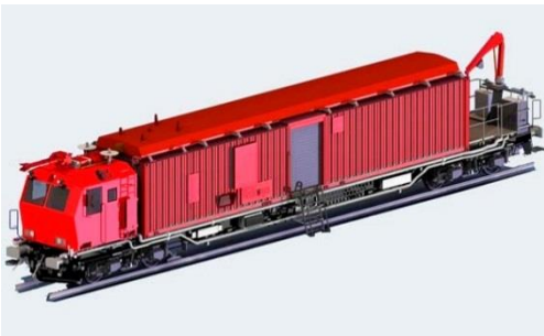
Рис. В. 1. Самохідна платформа пожежного аварійно-рятувального поїзда
