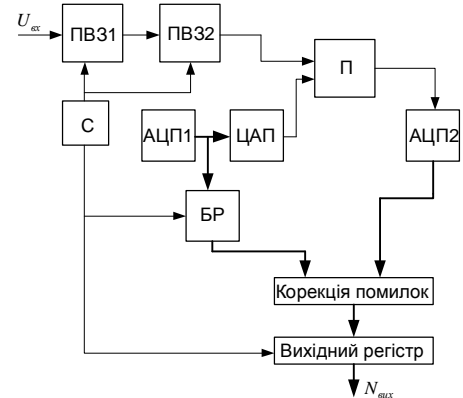
Рис. 3. Структура двоступеневого конверсного АЦП з корекцією помилок
