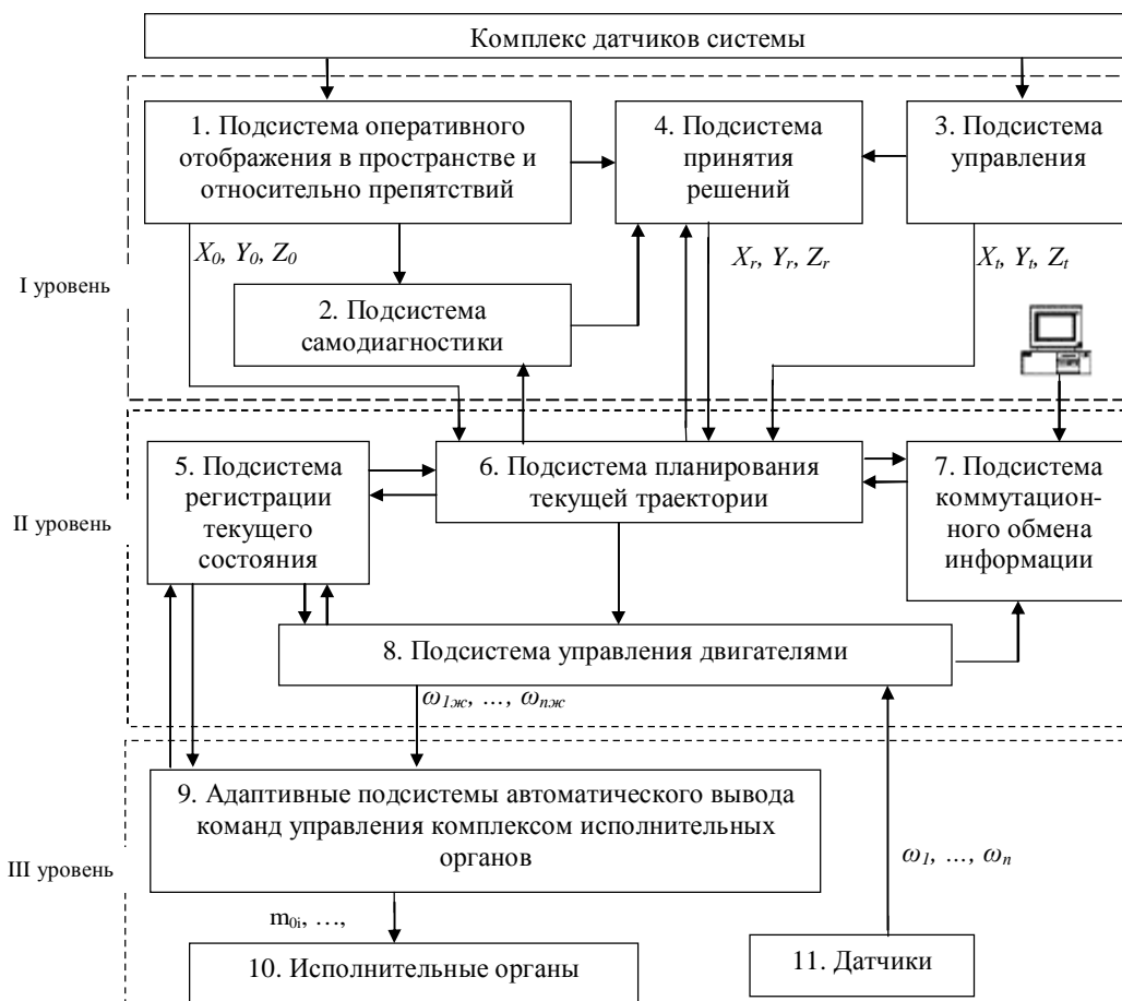
Рис. 1. Структура интеллектуальной системы управления мобильным роботом
